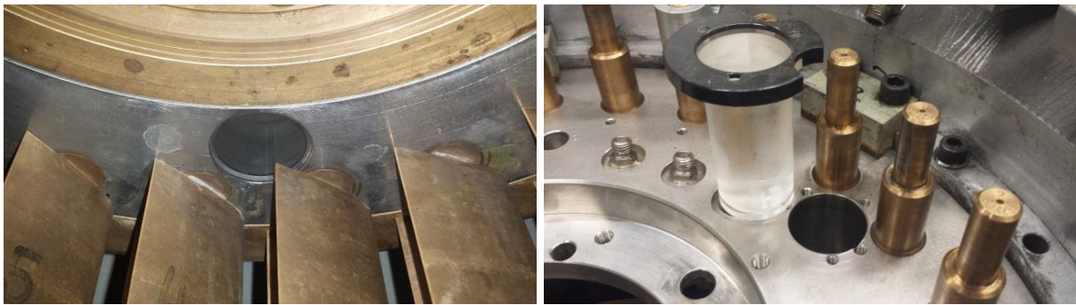
Abbildung 2.4: Plexiglaseinsatz im schaufelfreien Raum. Links: Ansicht aus dem Inneren der Modellturbinen. Rechts: Ansicht von oben vor der Montage.
