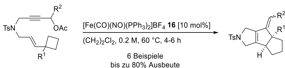
Abbildung 127: Allgemeines Reaktionsschema zur Fe-katalysierten Cycloisomerisierung von Cyclobutyleninen.
