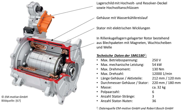
Abbildung 1-3: Betrachtete permanentmagnetisch erregte Synchronmaschine SMG 180
