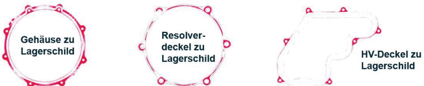
Abbildung 5-46: Experimentell gemessene Druckverteilungen an Gehäusefügestellen, vgl. [104]
