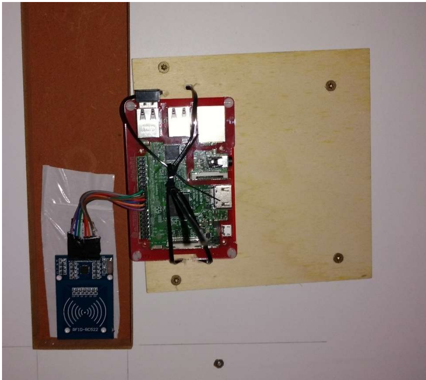
Abbildung 13-5: Befestigung NFC-Lesegerät und Raspberry Pi
