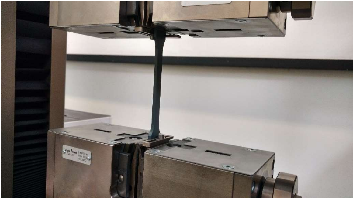
Abbildung 9-1: Flache Proben in der Zugprüfmaschine
