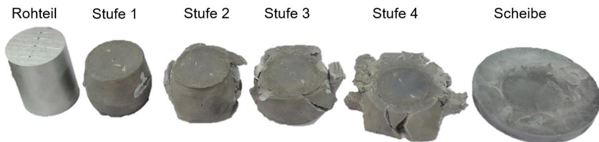
Bild 75: Darstellung aller vier Stufen der Step-Shot-Versuche sowie der Endgeometrie „Scheibe“ für den Werkstoff \text{AlSi7Mg0,3}
