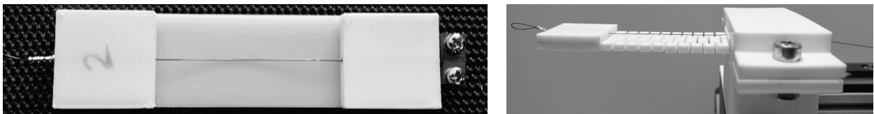
Abbildung 5.29: Probe mit eingespanntem FG-Draht und Befestigung im Prüfstand
