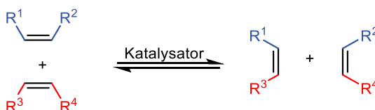
Schema 10: Prinzip der Olefinmetathese: katalytischer Austausch von Alkenfragmenten.
