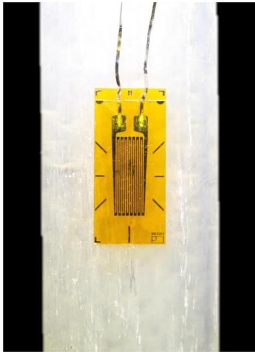
**Abbildung 2-3: Auf einem Prüfkörper aus GFK aufgeklebter DMS**
