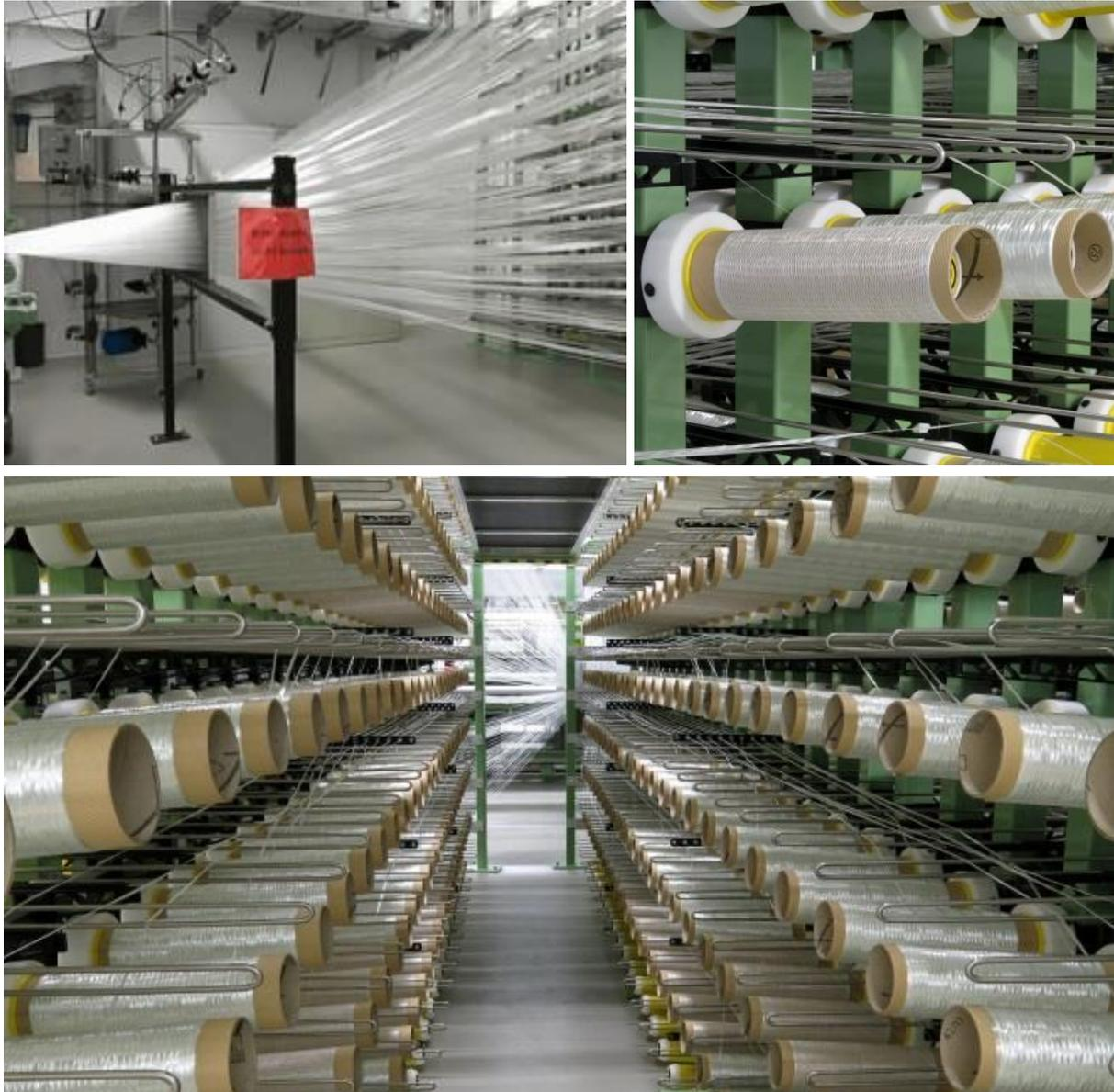
**Abbildung 5-3: Stationäres Abrollgatter mit tangentialem Spulenabzug, Spannungsausgleich und mechanisch einstellbarer Fadenspannung**
