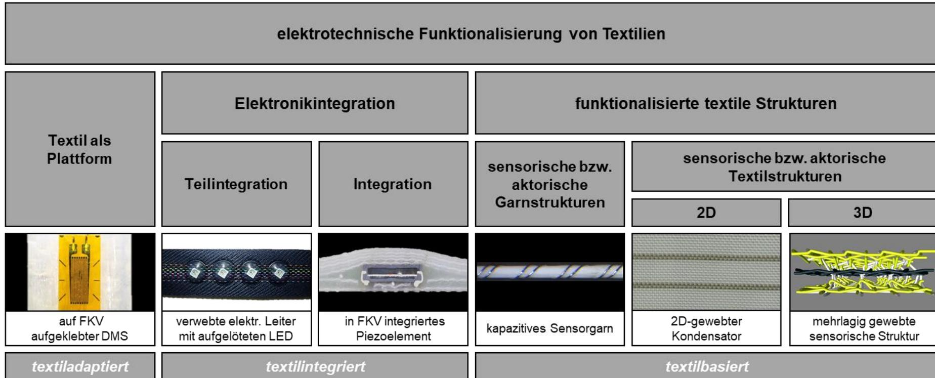
Abbildung 2-16: Zusammenfassung verschiedener Möglichkeiten zur elektrotechnischen Funktionalisierung von Textilien und Beispiele dazu
