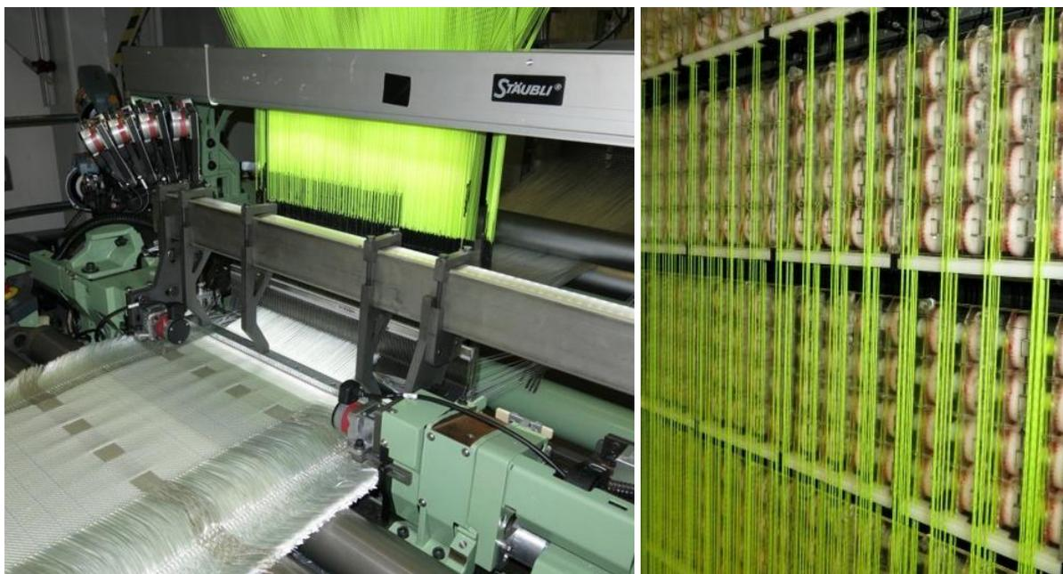
Abbildung 5-2: Stäubli-Jacquard-Maschine Unival 100 mit Webharnisch für die Übertragung des Fachhubs auf die einzelnen Kettfäden (links) und den Hubaktoren in der Jacquardmaschine (rechts)
