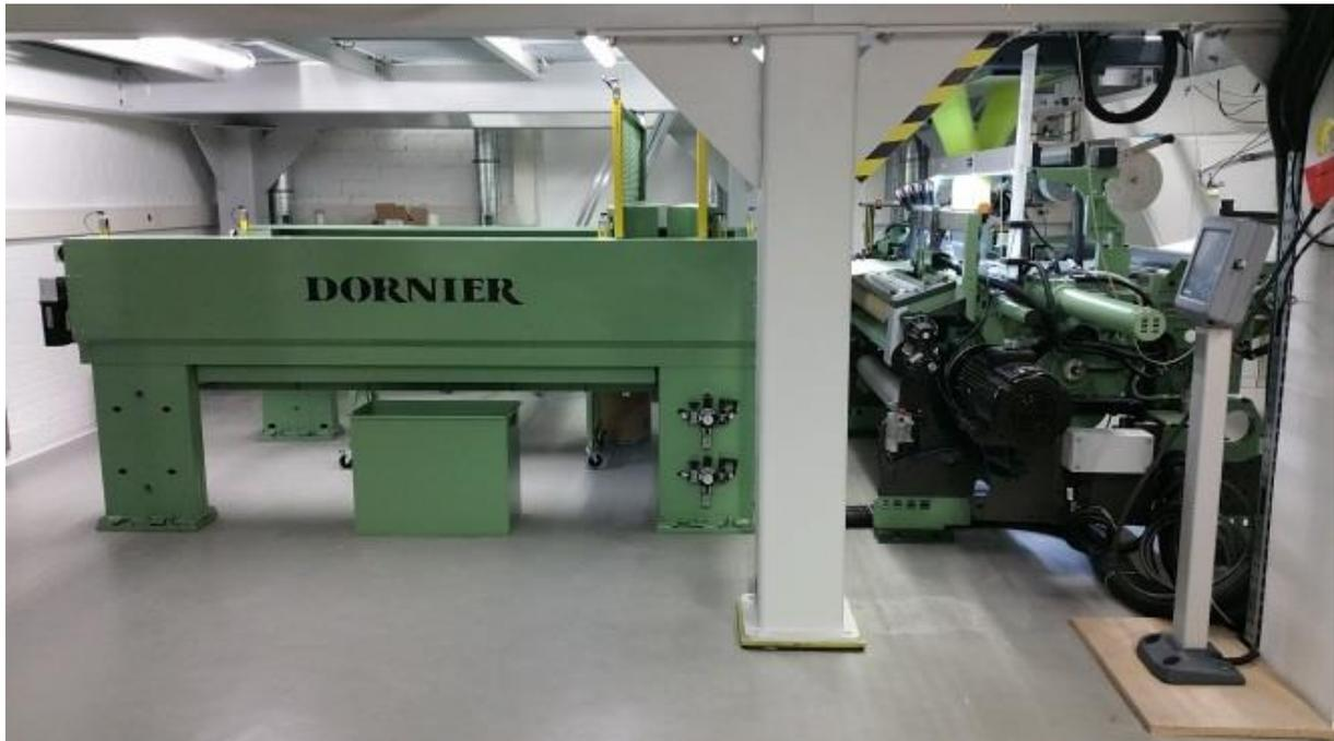
Abbildung 5-1: Dornier Mono-Greiferwebmaschine P2 (rechts) mit Horizontalabzug HTO (links) der Mehrlagengewebe
