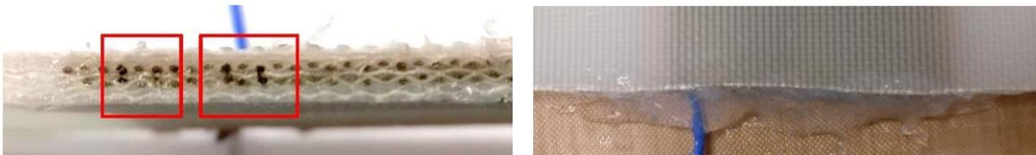
**Abbildung 4-8: Links: Spuren von Überschlügen am Probenrand; rechts: Mit Silikon isolierte Probenkante**
