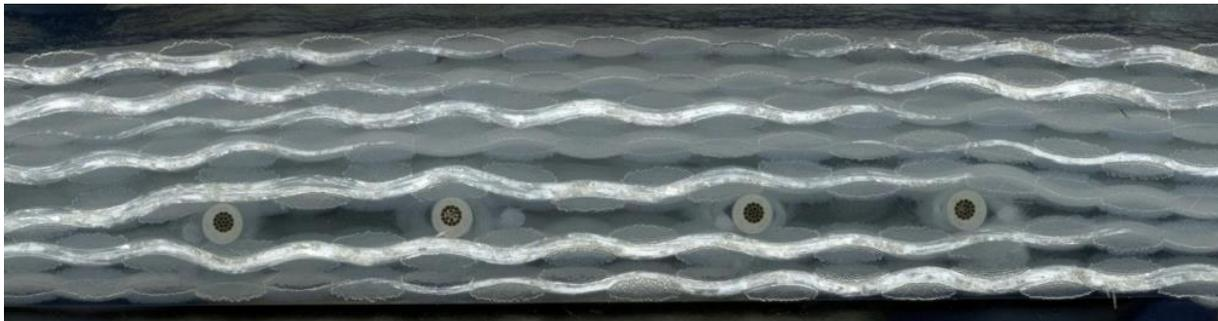
**Abbildung 2-6: Querschnittsansicht eines FKV mit auf ein Verstärkungsgewebe aufgestickten Mikrokabeln**
