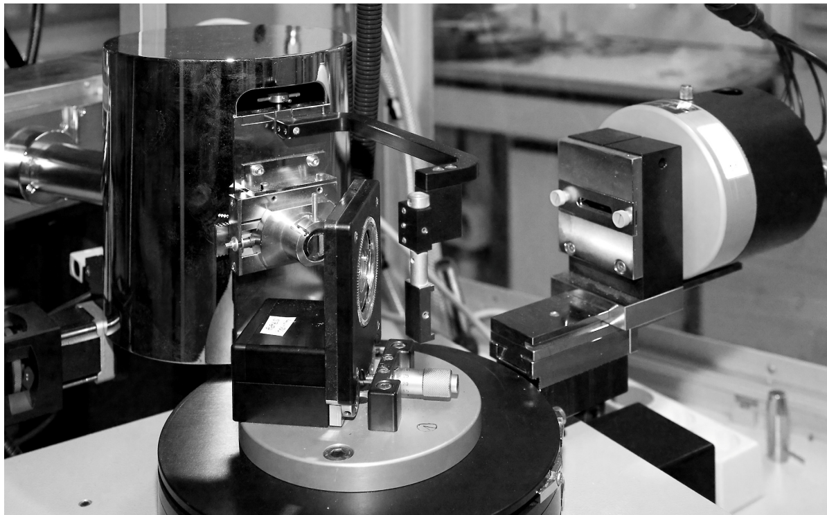
Abb. 2.2.2.a: Pulverdiffraktometer STADI-P der Firma STOE & Cie. Links im Bild befindet sich der Kollimator, der Probenhalter in der Bildmitte und der Detektor rechts.
