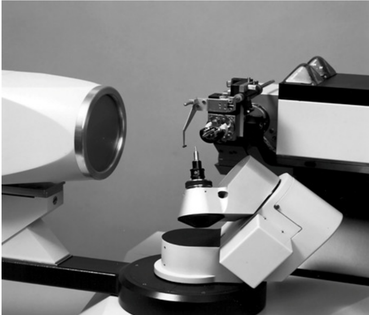
Abb. 2.2.3.b: Einkristalldiffraktometer \kappa -CCD der Firma NONIUS. Links im Bild befindet sich der CCD-Flächendetektor, in der Bildmitte der Goniometerkopf und dahinter die Strahlenquelle.
