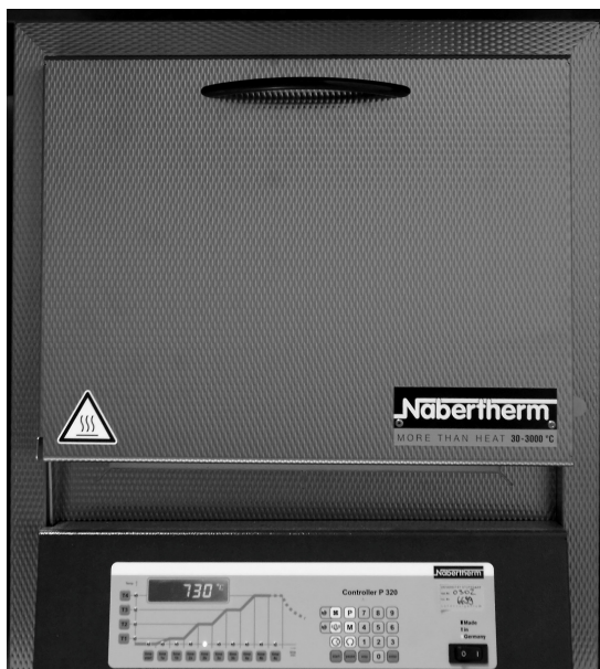
Abb. 2.1.4.a: Muffelofen der Firma NABERTHERM mit automatischer Temperatursteuerung.
