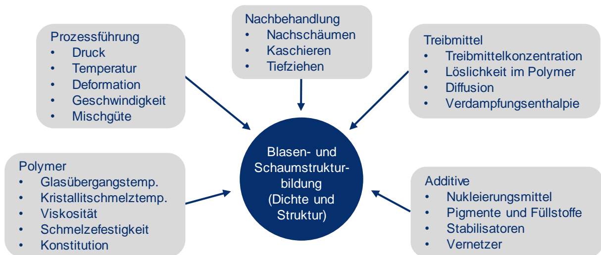
Bild 3: Einflussfaktoren auf die Blasen- und Schaumstrukturbildung nach [11, 22]
