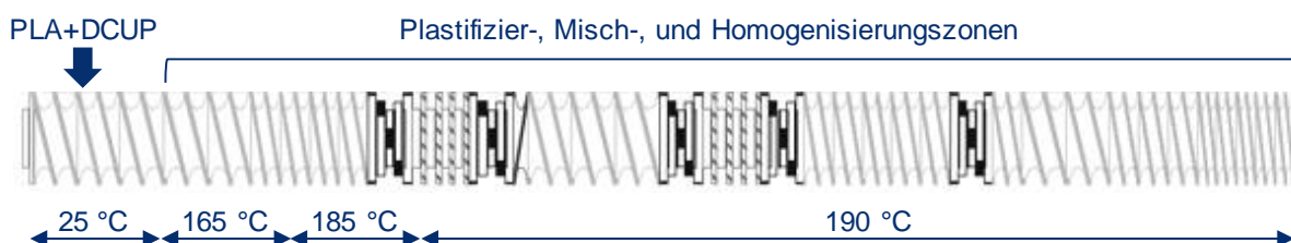
Bild 26: Schneckenkonzept der reaktiven Extrusion von PLA
