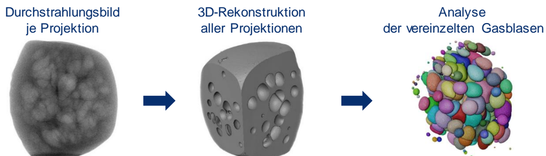
Bild 34: Ablauf der CT-Analyse am Beispiel eines geschäumten PLA-Granulates bei 200 °C und 0,22 M.-% N 2
