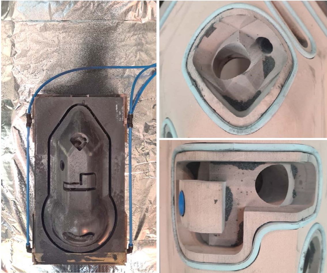
Abbildung 6-46: Spangutablagerungen bei Raumabsaugung mit gezielter Zuluft (links) und Raumabsaugung mit Prozessluftrückführung (rechts)
