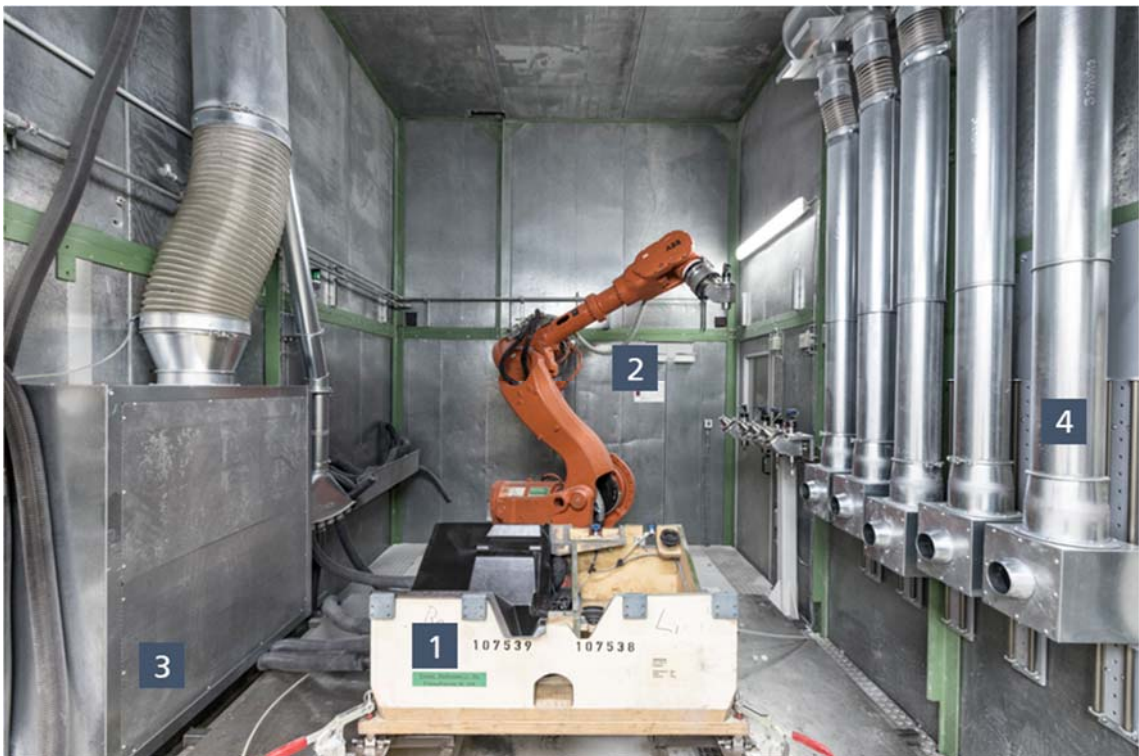
Bauteil auf Spannvorrichtung (1); Fräsroboter (2); Absaughaube (3); höhenverstellbare Blasdüsen (4)
