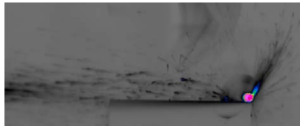
Abbildung 5-27: Verschiedene Phasen der Fräsbearbeitung im Trennschnitt; schematische Darstellung (links); Wärmebildaufnahme im realen Schnitt (rechts)
