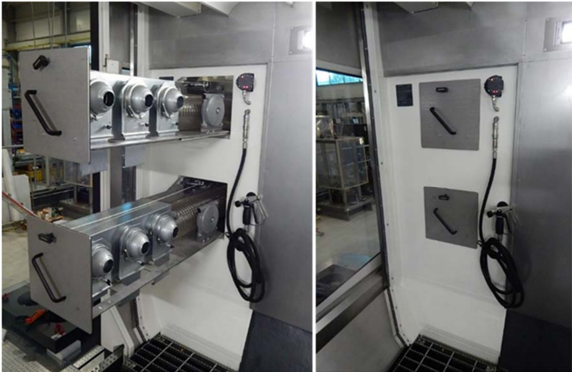
Verstellbare Blasdüseneinheiten in ausgefahrenem Zustand (links); Blasdüseneinheit in Seitenwand eingefahren (rechts)
