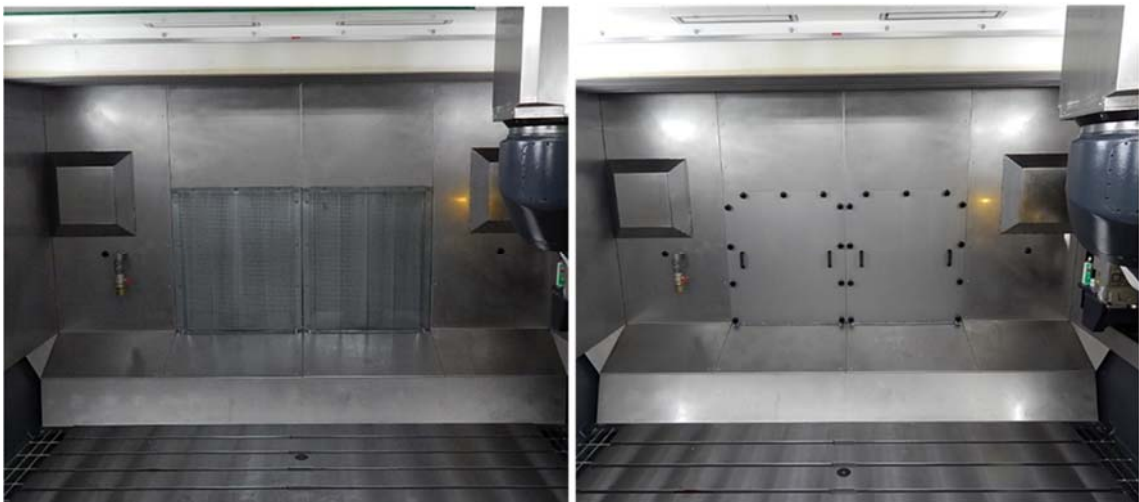
Absaughauben in Maschinenrückwand integriert (links); Absaughauben für Zerspanung mit Kühlschmierstoff verschlossen (rechts)
