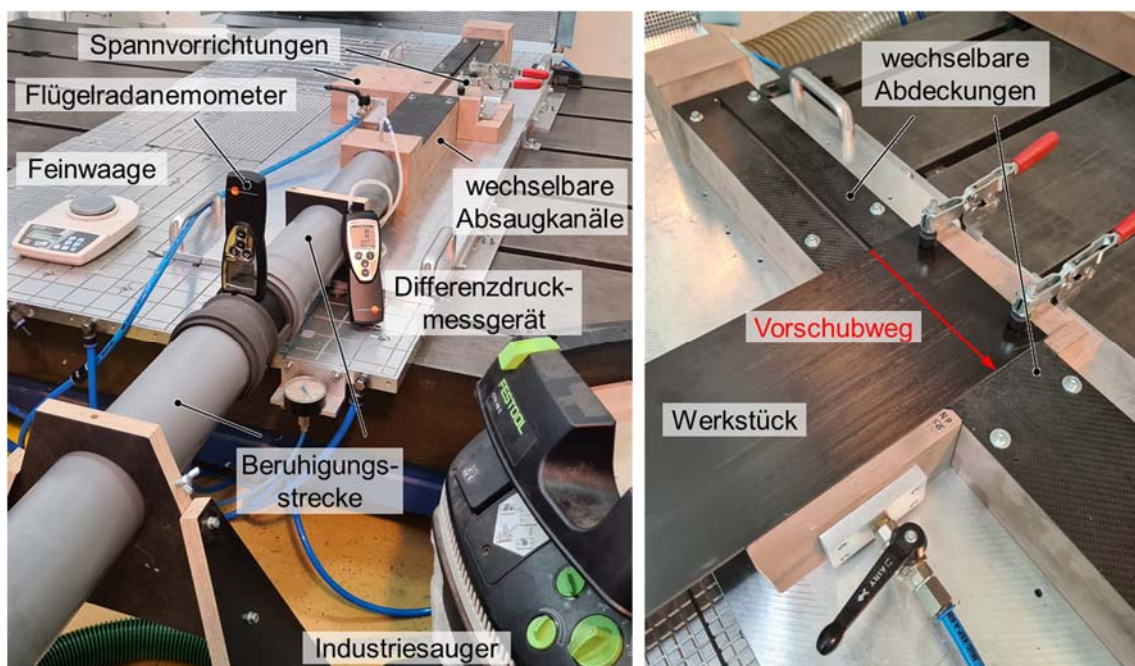
Abbildung 6-14: Prüfstand zur Untersuchung der spannsystemintegrierten Absaugung
