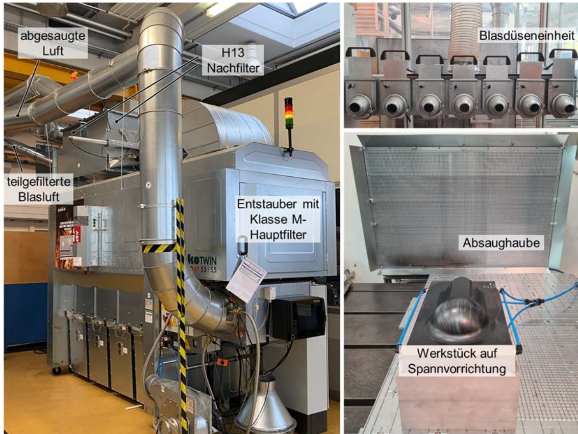
Abbildung 6-45: Mobiler Entstauber mit Prozessluftrückführung (links), Blasdüseneinheit (rechts oben) und Werkstück vor Absaughaube (rechts unten)
