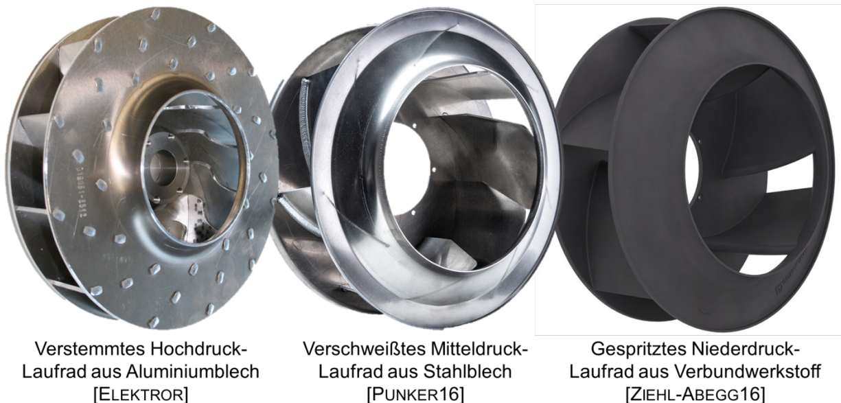
Bild 3.2: Konstruktive Ausführungen von Ventilator-Laufrädern
