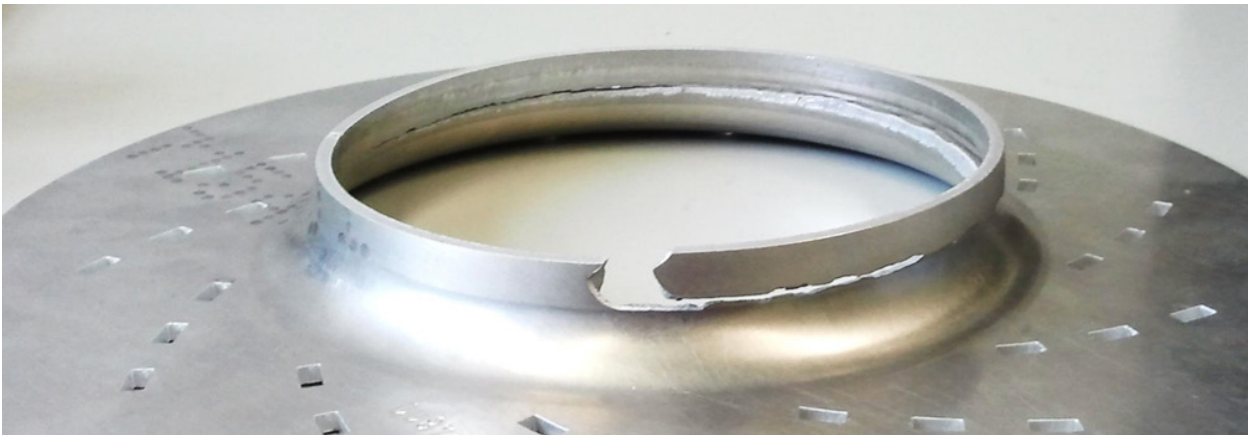
Bild 8.12: Risse beim Umformen der Deckscheibe aus Aluminium EN-AW 6082
