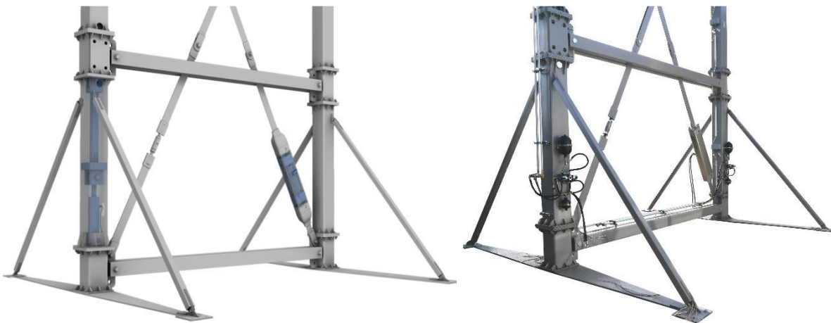
Bild A.8: CAD-Modell und fotografische Aufnahme des Funktionsprototypen der Aktorik [WEIDNER19, S. 4 f.]
