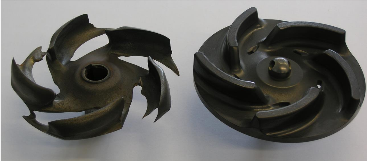
Bild 2.10: Pumpenlaufräder aus Grauguss (links) und Siliziumnitrid (rechts) nach 394 Stunden Betrieb in mit Sand versetztem Wasser
