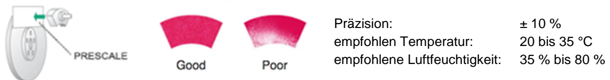
Bild 5.1: Anwendungsbeispiel von FUJIFILM Druckmessfolien des Typs Prescale an einer Scheibenbremse (links) und Produktspezifikationen (rechts) [FUJIFILM23A], [FUJIFILM23B]
