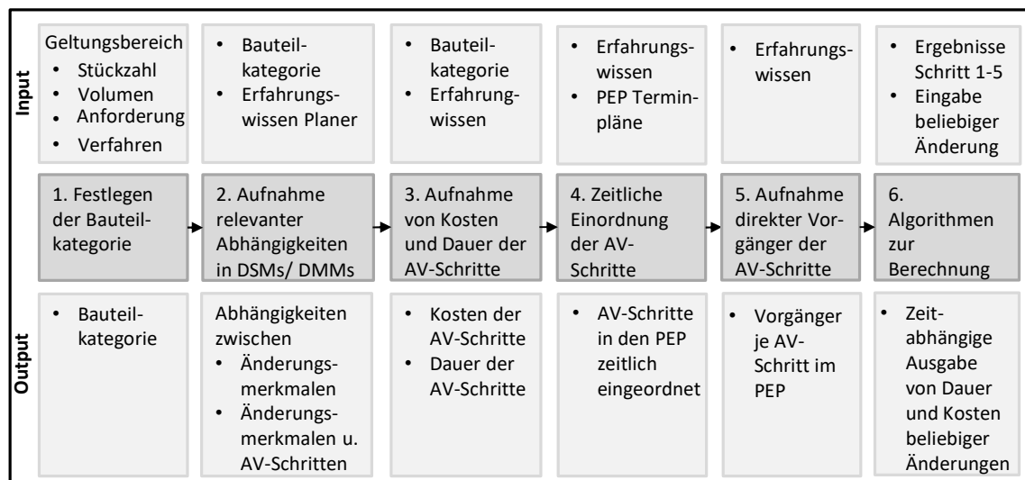
Abbildung 6.23: Methode zur Bewertung des AM-Änderungsaufwands (in Erweiterung zu Kratzer et al. 2021b)
