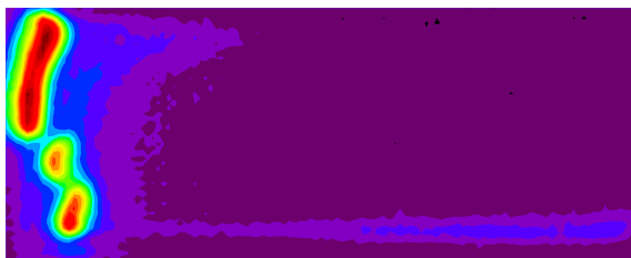
Abb. 45: Foto- und IR-Aufnahmen des Katalysators während einer Wärmeexplosion ohne Zündung der Gasphase. Der Bildbereich entspricht jeweils der Fläche der Katalysatorbeschichtung (50 mm × 20 mm); Strömungsrichtung von links nach rechts. x_{\text{Ethen}} = 67 \text{ Mol-\%} ; x_{\text{O}_2} = 33 \text{ Mol-\%} ; p_0 = 5 \text{ bar} ; T_R = 370^\circ\text{C} ; d_\mu = 0,25 \text{ mm} ; d_{\text{Kat}} = 0,28 \text{ mm} ; m_{\text{Kat}} = 370 \text{ mg} .
