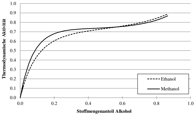
Abb. 17: Thermodynamische Aktivität von Methanol (durchgezogene Linie) und Ethanol (gestrichelte Linie) als Funktion des Stoffmengenanteils des Alkohols.
