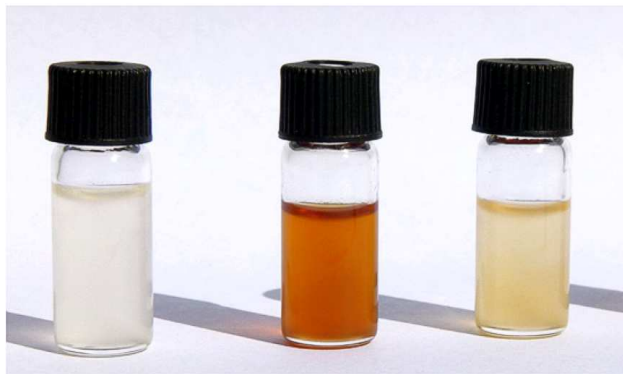
Abbildung 4.16.: Thermisches Durchgehen: Linke Probe: 210 °C, Mitte: 213 °C, Rechts: 210 °C.
