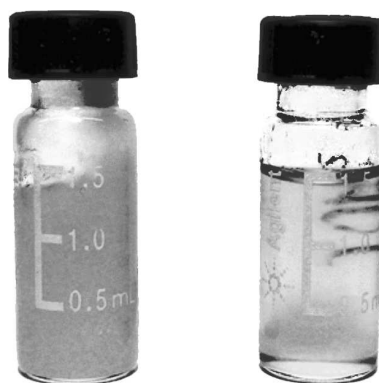
Abbildung 4.12.: Einfluss der Mischtemperatur auf die Produkteigenschaften für den Interdigitalmischer ( \varepsilon_0 = 3 , \vartheta_R = 210\text{ °C} ):
