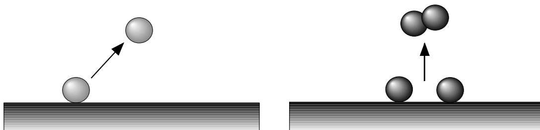
Abbildung 3.3: Vergleich von einfacher (links) und assoziativer Desorption (rechts).
