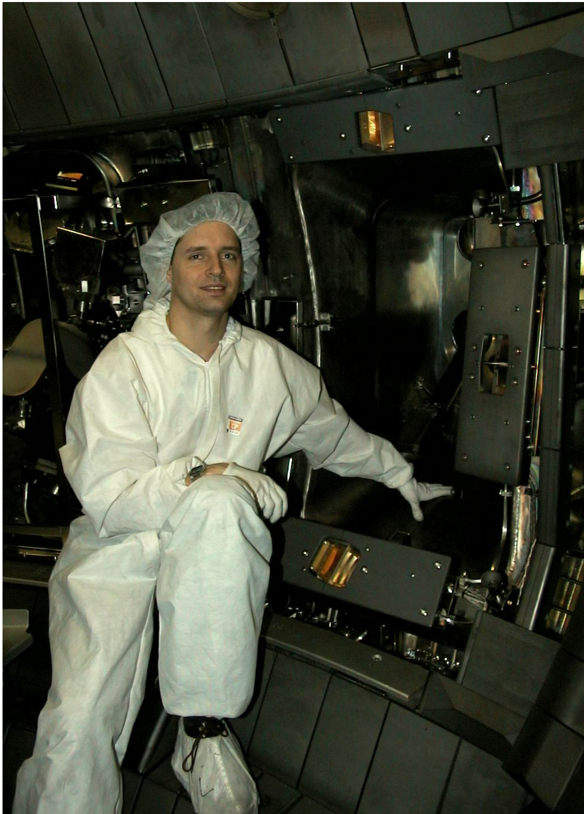
Abbildung C.11: Photographie des A-Ports in Sektor 13 von ASDEX Upgrade. Die optimierten O-Mode Antennen sind am oberen Rand des A-Ports angebracht, die X-Mode Antennen befinden sich am unteren Rand.
