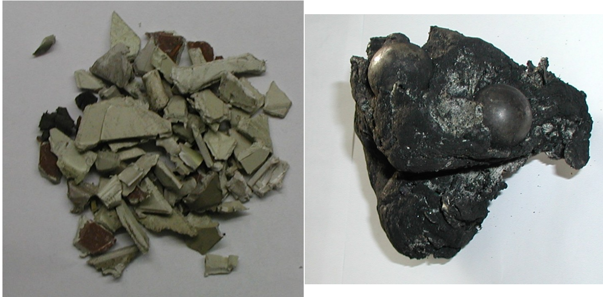
Abbildung 5.12: Zerkleinerte Monitorgehäuse der Firma R-plus und der Rückstand nach einer Pyrolyse bei 350 °C für 2 Stunden im Haloclean®-Drehrohr.
