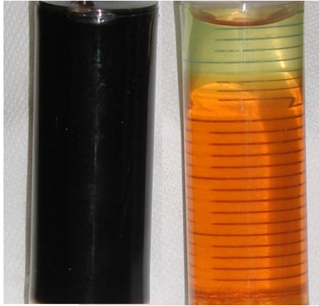
Abbildung 7.23: Unbehandeltes Pyrolyseöl aus den Versuchen mit bromhaltigen Leiterplatten (links) und nach der Behandlung mit PP im Rührkessel bei 350°C und 5 h.
