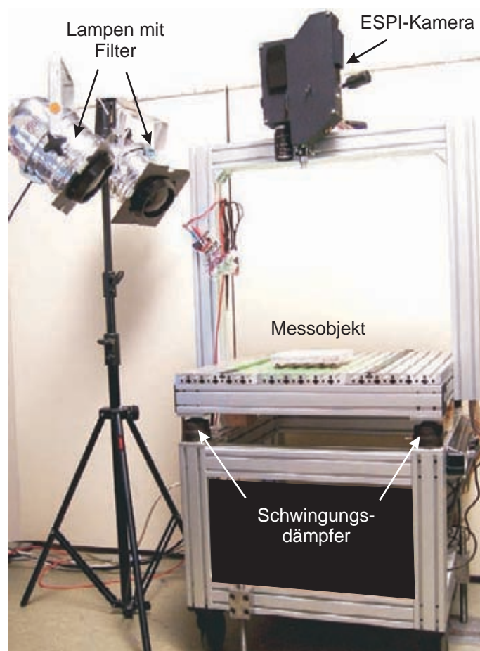
Abbildung 2.5: Messaufbau mit ESPI-Kamera, Lampen und Messtisch.
