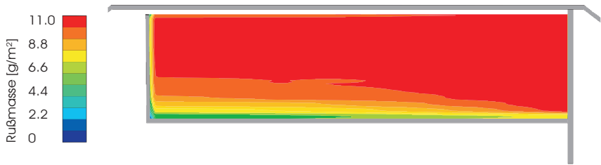
Abbildung 3.6: Rußmassenverteilung auf der Taschenoberfläche bei einer mittleren Beladung von 10 \text{ g/m}^2
