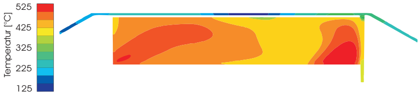
Abbildung 5.15: Temperatur der Festkörper 100 Sekunden nach Beginn der Regeneration
