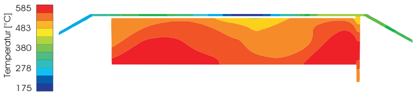
Abbildung 5.16: Temperatur der Festkörper 200 Sekunden nach Beginn der Regeneration
