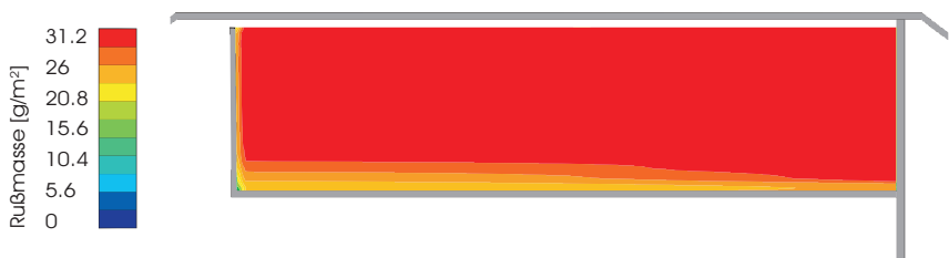
Abbildung 3.8: Rußmassenverteilung auf der Filteroberfläche bei einer mittleren Beladung von 30 \text{ g/m}^2
