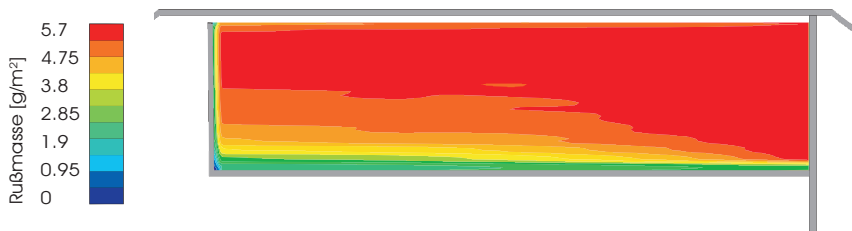
Abbildung 3.5: Rußmassenverteilung auf der Taschenoberfläche bei einer mittleren Beladung von 5 \text{ g/m}^2
