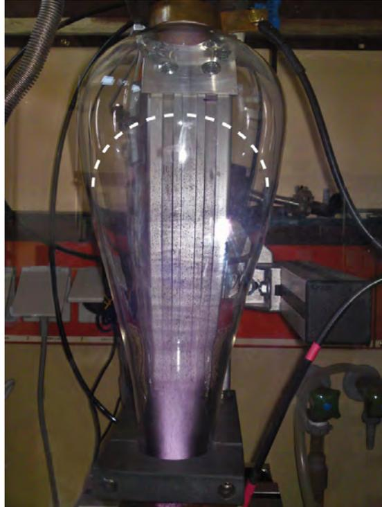
**Abb. 4-25: Fotografie der sich im asymmetrisch-konvexen Fließbettreaktor (links) bei den simulierten Randbedingungen ausbildenden „CNT-Wolke“ (Grenzbereich sichtbarer Agglomerate ist durch die weiße unterbrochene Linie angedeutet)**
