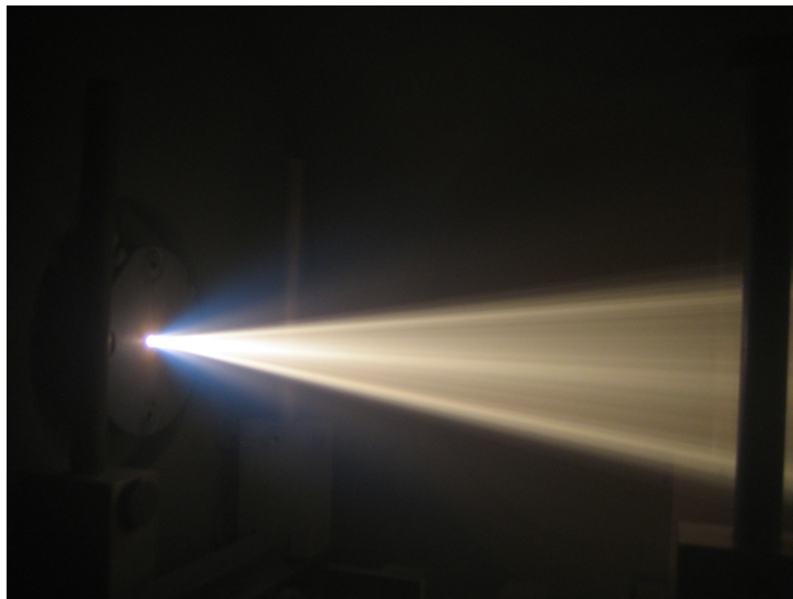
Abbildung 6.1: Abbildung der Beschichtungszone hinter der Düse. Neben der thermischen Emission der Partikel erkennt man das bläuliche Leuchten des Siliziumgases.
