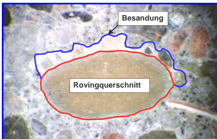
Abbildung 3-26: Unter leichter Vorspannung imprägniertes und einseitig besandetes Aramidlegele eingebettet in Beton.
