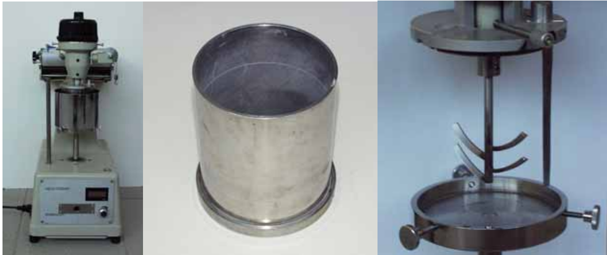
Abbildung 9-10: Viskosimeter, Messtopf und Detail des Eintauchpaddels zur eigentlichen Messung.
