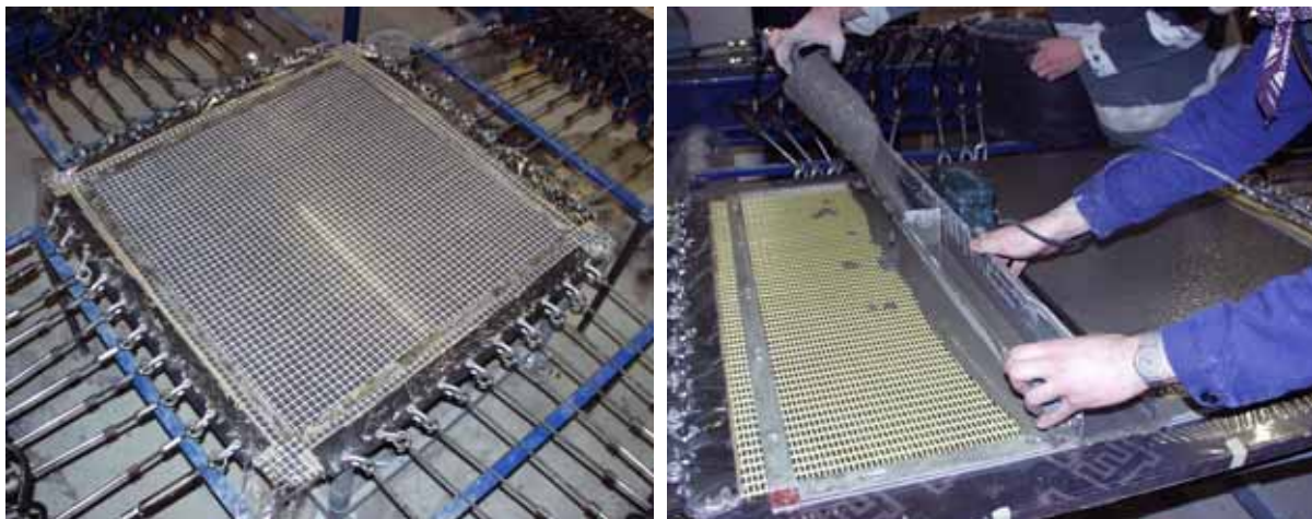
Abbildung 3-9: Biaxialspannrahmen mit eingebautem Textil (links), Betoniervorgang einachsiger vorgespannter Aramidbewehrter Platte (rechts).
