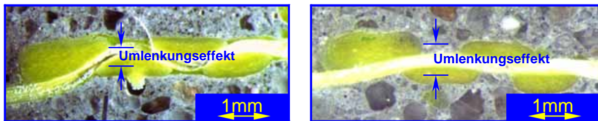
Abbildung 3-28: Querschnitte von SBR-beschichteten Aramidgewebe eingebettet in Beton: vorgespannt (links), nicht vorgespannt (rechts).
