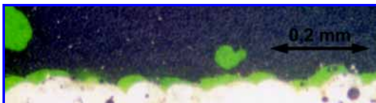
Abbildung 3-20: Verbundzone eines imprägnierten Carbonrovings nach 10 Tagen Lagerung in 80°C heißem Wasser (grün: Ablösung).
