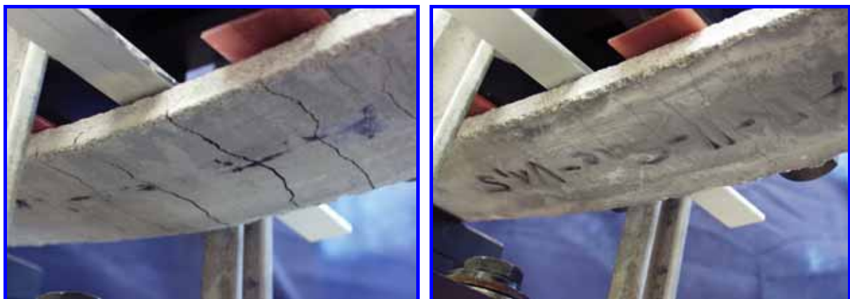
Abbildung 3-34: Nicht vorgespannte AR-glasbewehrte Platte (links), vorgespannte AR-glasbewehrte Platte (rechts) kurz vor dem Versagen (AR).
