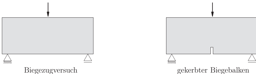
Abbildung 4.3: Schematische Darstellung des Biegezugversuchs
