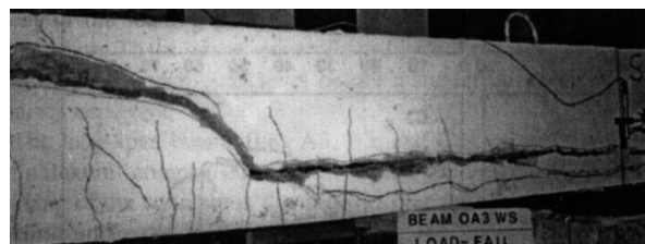
Abbildung 8.27: Experimentelles Versagen des Balkens OA3 nach Vecchio & Shim [111]
