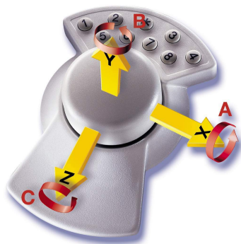
Abbildung 5.11: Die SpaceMouse ® der Firma 3Dconnexion besitzt drei translatorische und drei rotatorische Freiheitsgrade, welche durch Drücken bzw. Drehen an der zentralen Zylinderkappe angesprochen werden.
