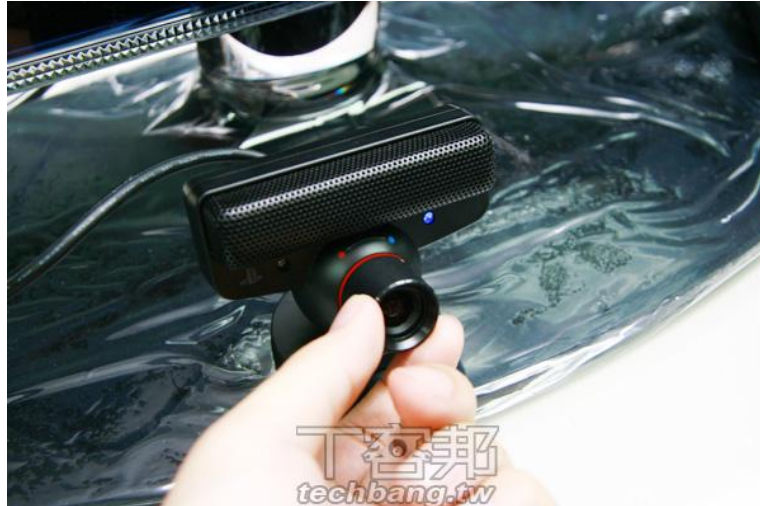
Abbildung 20 – Playstation Eye Kamera. Sie empfängt das Licht des Bewegungskontrollers, um die Bewegungen des Spielers zu berechnen. Quelle: Techbang Webseite 18
