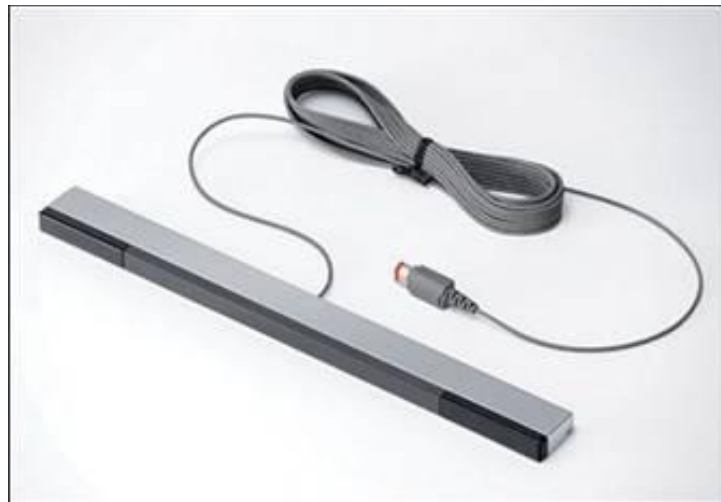
Abbildung 52 – Sensorleiste der Wii. Mittels Infrarotstrahlen wird ermittelt, wo sich die Handsender befinden. Quelle: Wisegamers Webseite 50
