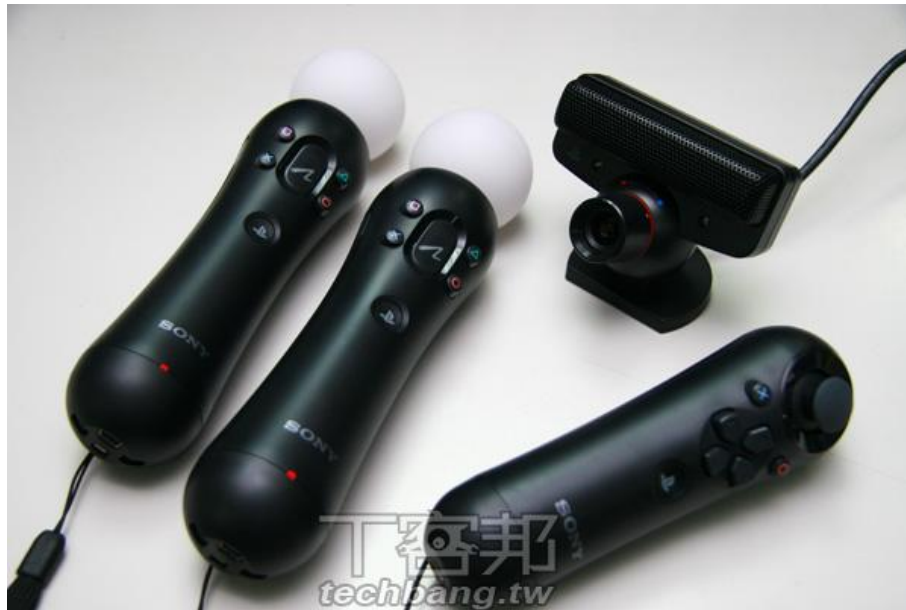
Abbildung 53 – Die drei Teilsysteme der Playstation Move. Diese umfassen den Motion Controller, den Navigation Controller und das Playstation Eye. Quelle: Techbang Webseite 51
