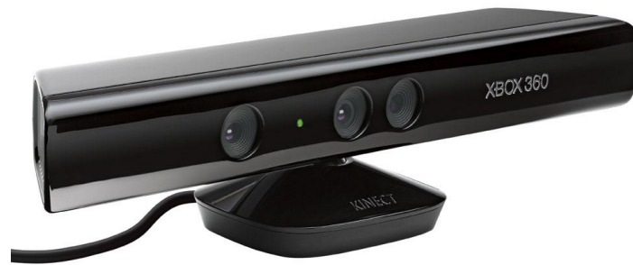
Abbildung 40 – Kinect für Xbox360. Das Gerät erkennt mittels eines Sensors die Gesten eines oder mehrerer Benutzer und überträgt diese auf den Avatar. Handelt es sich dabei um ein menschenähnliches Abbild, gelingt die Interaktion sehr gut. Quelle: Play Webseite 36
