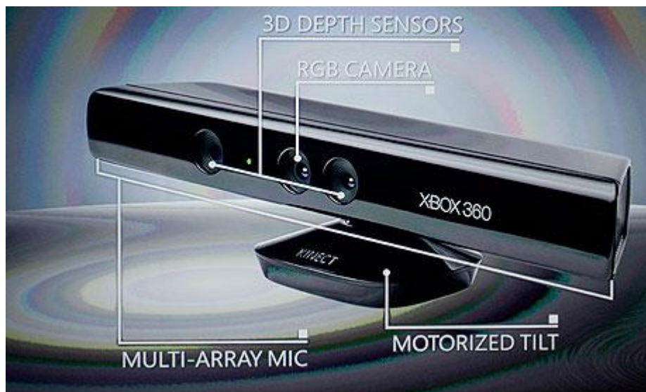
Abbildung 49 - Microsoft Kinect Sensoren. Dargestellt sind die verschiedenen Sensoren der Kinect Konsole: Die RGB Kamera, die Tiefensensoren und die Mikrofone. Quelle: Games Blog 47
