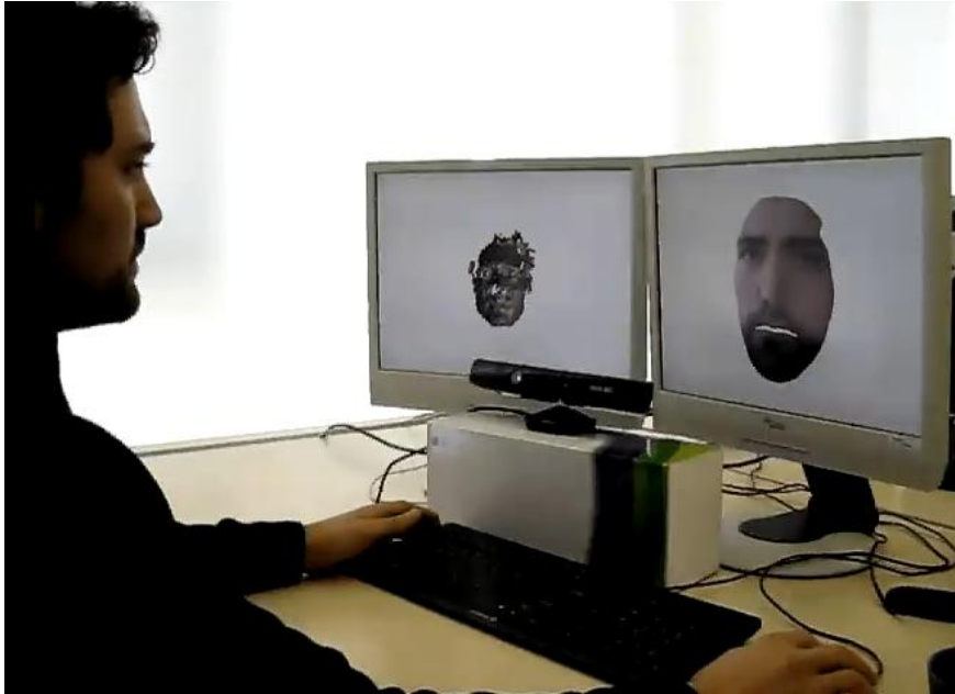
Abbildung 12 – Aufbau zur Avatarerstellung per Microsoft Kinect Konsole nach Zollhöfer et al. Auf dem linken Monitor wird das aufbereitete Signal vom Kinect Sensor dargestellt, anhand dessen der Benutzer seinen Kopf positionieren kann. Auf dem rechten Monitor ist bereits das Endergebnis sichtbar. Quelle: Video zum Verfahren von Zollhöfer et al. 12
