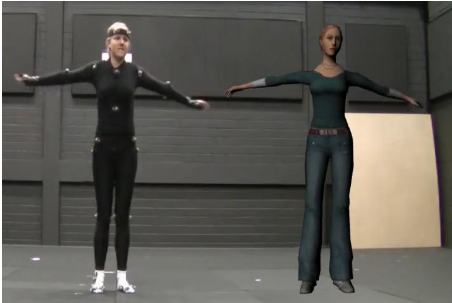
Abbildung 4 – Motion Capture Verfahren. Die zu erfassende Person wird an bestimmten Körperstellen mit Markern versehen, die von Spezialkameras erfasst werden. Quelle: Webseite von Stephan Streuber beim Cyberneum 6
