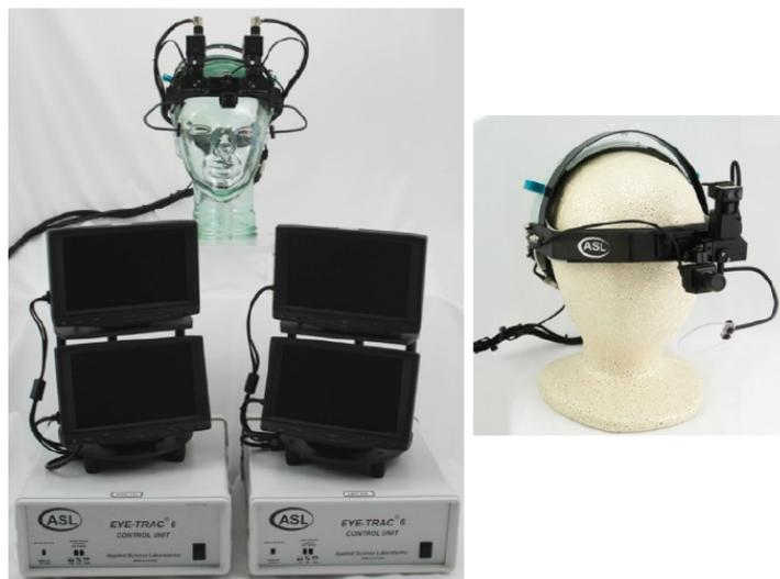
**Abbildung 2.27:** Ein binokulares (links) [39] und monokulares (rechts) [38], kopfgetragenes Eyetracking-System. Bei monokularen Systemen wird eine Kamera und ein Spiegel für beide Augen, bei binokular wird für jedes Auge eine eigene Kamera und ein eigener Spiegel verwendet. Die Firma ASL bietet außerdem die Möglichkeit, die Eyetracking-Daten direkt auf einem Kontrollcomputer (getrennt) anzeigen zu lassen.
