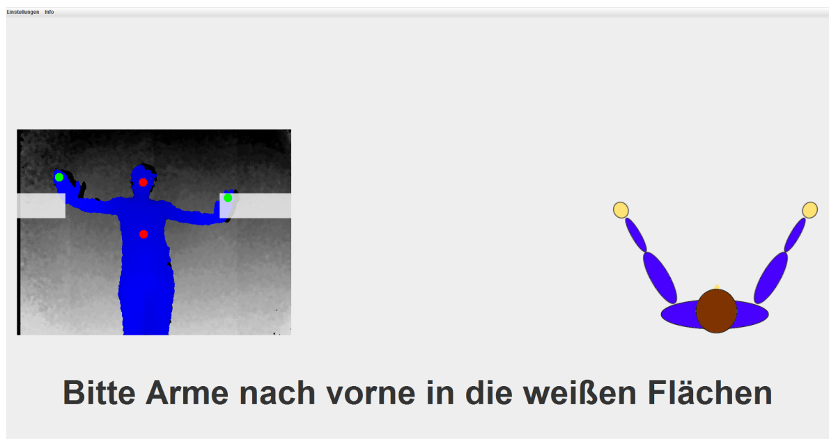
Abbildung 3.3: Kalibrierung der Armweite. Zu sehen sind die rechteckigen Zielflächen seitlich der Schultern, die mit den Handindikatoren getroffen werden müssen. Die Kalibrierung des Handabstands wird für die Zoomgeste verwendet. Durch die Kalibrierung kann festgestellt werden, welches der maximale Armabstand ist. Somit können die Abstände der Stufen bei der Zoomgeste berechnet werden.
