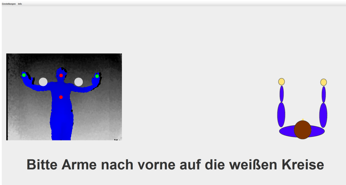
Abbildung 3.2: Kalibrierung der Armlänge. Zu sehen sind die weißen Ziele über den Schultern, die mit den Handindikatoren getroffen werden müssen. Die Kalibrierung der Armlänge wird dazu verwendet, präzise feststellen zu können, wann die Hand als vorne erkannt wird.
