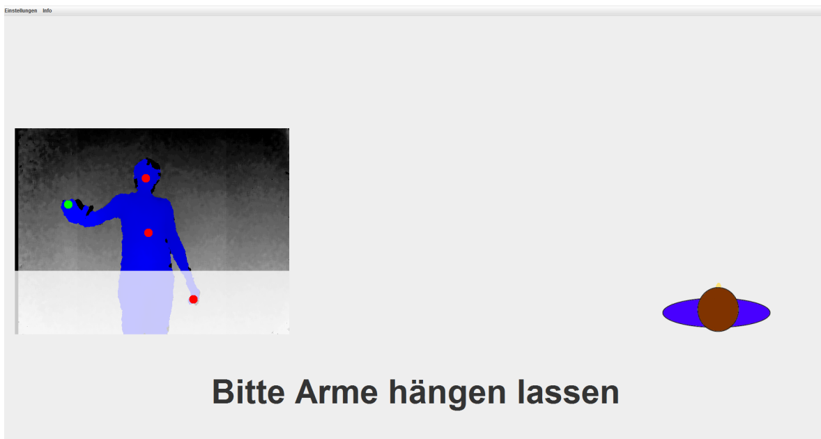
Abbildung 3.4: Letzter Schritt der Kalibrierung. Zu sehen ist die Zielfläche, die den gesamten Raum unterhalb des Torsos einnimmt. Beide Arme müssen nach unten hängen, sodass sich die Hände innerhalb der Zielfläche befinden. Dieser Schritt ist nötig, um die Hände des Benutzers in eine neutrale Position zu bewegen, bevor er die Steuerung der Karte übernimmt.
