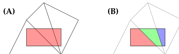
Abbildung 2.1: Schnitt eines Gitters mit der Bounding Box und die daraus resultierenden Polygone
