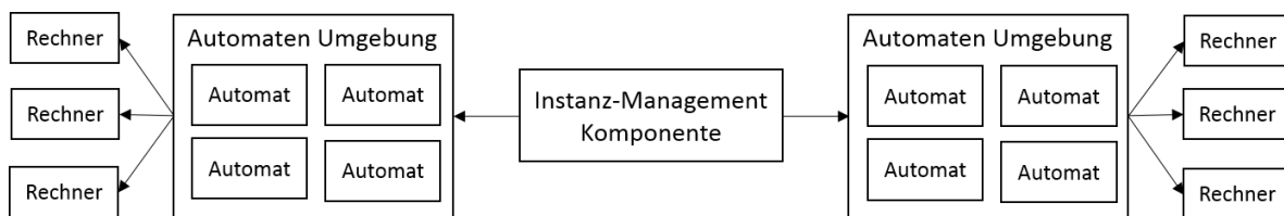
Abbildung 4.1.: Das Verhältnis der Instanz-Management Komponente zu den Automaten-Umgebungen.
