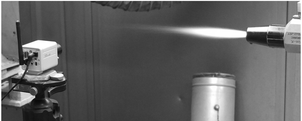
Abbildung 7.7: Kamerasystem bei der Messung am thermokinetischen Beschichtungsprozess.
