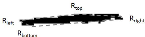
(a) Verwertbare Partikelabbildung als konvexes Objekt ( T_L \leq A_{Polygon}/A_{CCL} \leq T_H ).
