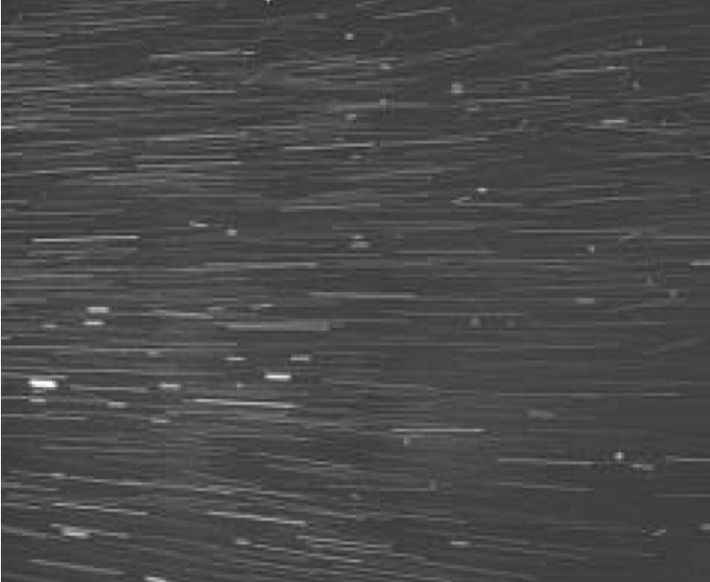
Abbildung 2.2: Bildaufnahme des Continuous-PIV-Verfahrens beim thermokinetischen Beschichten.
