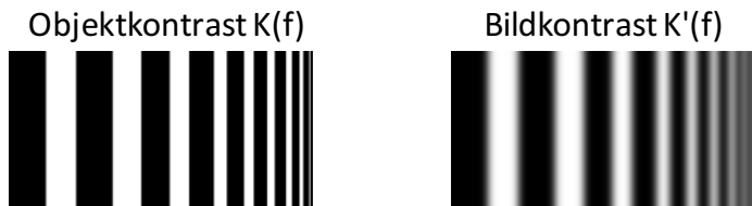
Abbildung 3.5: Objekt- und Bildkontrast in Abhängigkeit der Ortsfrequenz f .
