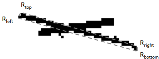
(c) Überlagerte Partikelabbildungen als ein Objekt (nicht akzeptiert, T_L > A_{Polygon}/A_{CCL} ).
