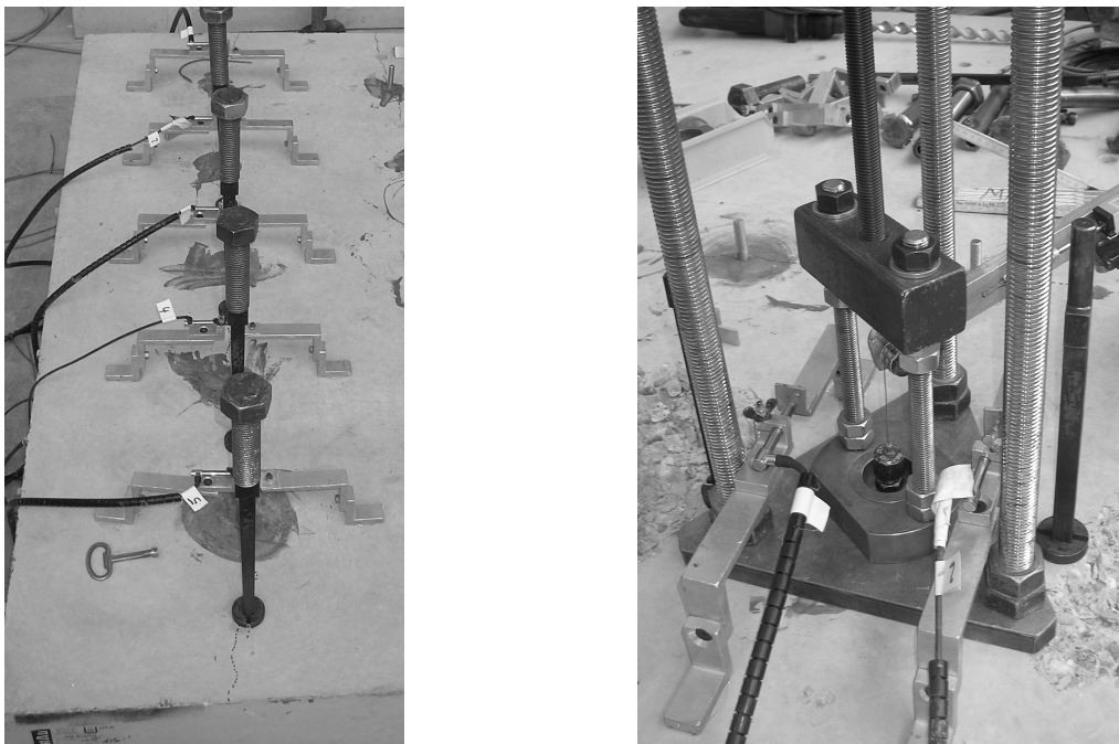
a) Risserzeugung mittels Risskeilen und b) Versuchsaufbau, gerissener Beton (enge Messeinrichtung zur Erfassung der Rissbreite während der Rissöffnung)
