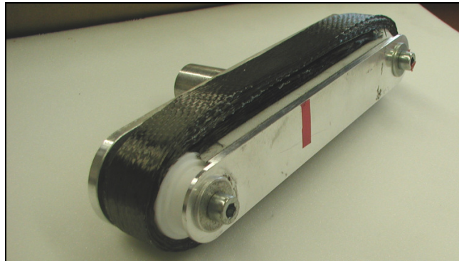
Abbildung 128: unverstärkte Querlenkerschlaufe nach dem Wickeln der Schlaufenlagen
