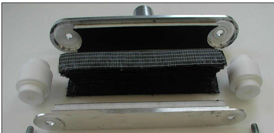
Abbildung 127: Vorrichtung zum Wickeln der Schlaufen mit Mittellaminat und Teflonbuchsen
