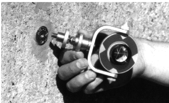
Abbildung 5.1: Reflektor mit Schraubhülse zur effektiven und genauen Realisierung eines Baustellenfestpunktfeldes.
