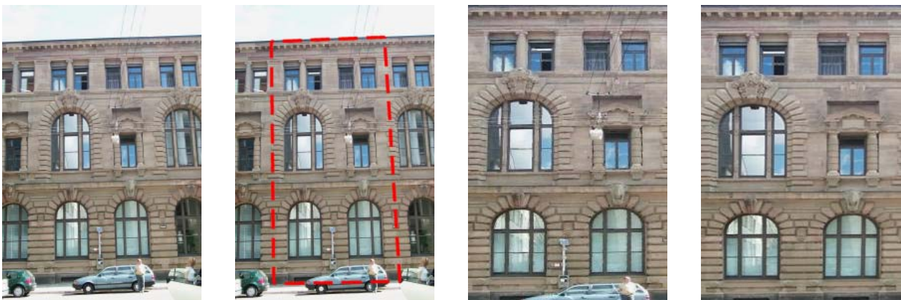
Abbildung 6-1: Die (manuelle) Texturextraktion umfasst (1) digitale Bildaufnahme und Korrektur der Linsenverzeichnung, (2) Selektion eines viereckigen Bildbereichs, (3) Berichtigung der perspektivischen Verzerrung und (4) Retuschieren von verdeckten Bildbereichen.
