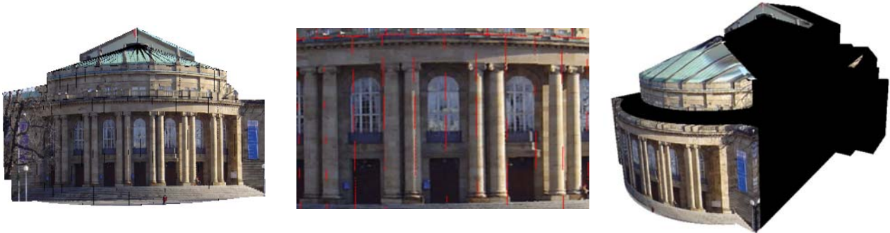
Abbildung 6-6: Automatisch texturiertes Gebäudemodell mit aktivierter Erkennung von Selbstüberdeckungen vom Aufnahmestandpunkt (links), mit rot hervorgehobenen Artefakten an den Polygongrenzen (Mitte) und aus einer anderen Betrachterposition (rechts).
