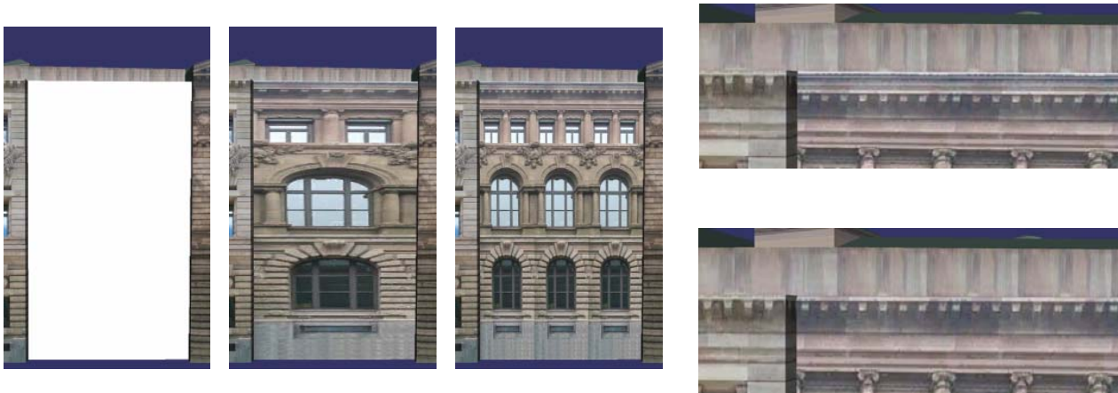
Abbildung 6-2: Die manuelle Platzierung des Texturbildes umfasst (1) Selektion des Fassadepolygons, (2) Selektion des Texturbildes, (3) Einstellung der Kachelungsparameter und (4) Feinabstimmung mit Texturen der Nachbarflächen.
