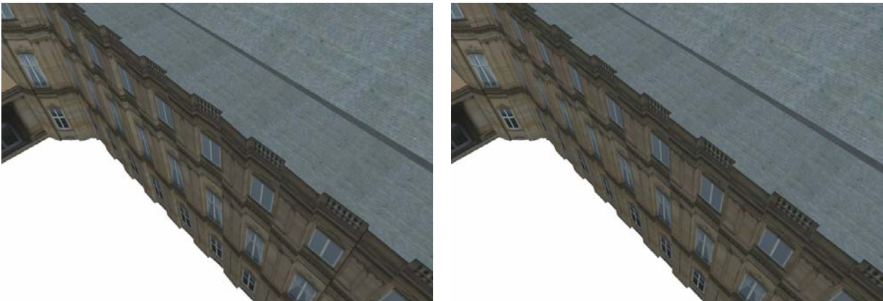
Abbildung 4-4: Die geometrischen Relationen des Gebäudemodells können aufgrund von Erfassungsungenauigkeiten nicht automatisch erkannt werden (links). Die Flächen des Gebäudemodells müssen erst von einem menschlichen Operateur manuell ausgerichtet werden (rechts).
