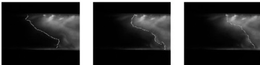
Bild 5.32: Erkennung des Plasmarands für verschiedene Schwellenwerte im Auswertalgorithmus.
