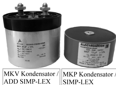
Bild 3.2: Beide in dieser Arbeit verwendete Kondensatortypen. Charakteristische Größen siehe Anhang B.
