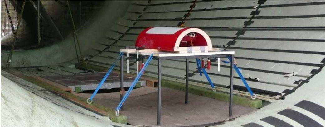
**Abbildung 135 Testaufbau Windkanalversuch Fallschirmsystem**
