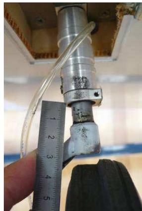
**Abbildung 39 Beispiel eines defekten Reifens eines anderen Demonstrators - Abrieb durch Ausdehnungserscheinungen bei hohen Geschwindigkeiten (Quelle: IFB, Universität Stuttgart)**
