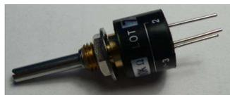
**Abbildung 31 Potentiometer VP12 Steuerflächenvermessung (Quelle: [19])**
