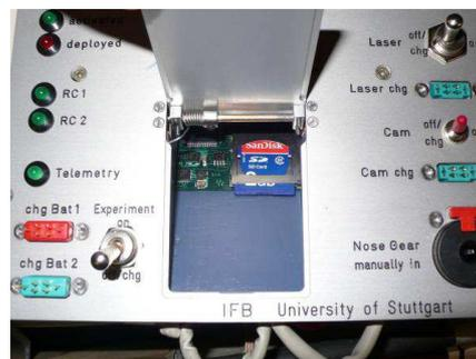
**Abbildung 37 SD Card Slot auf dem Haupt-HIB**
