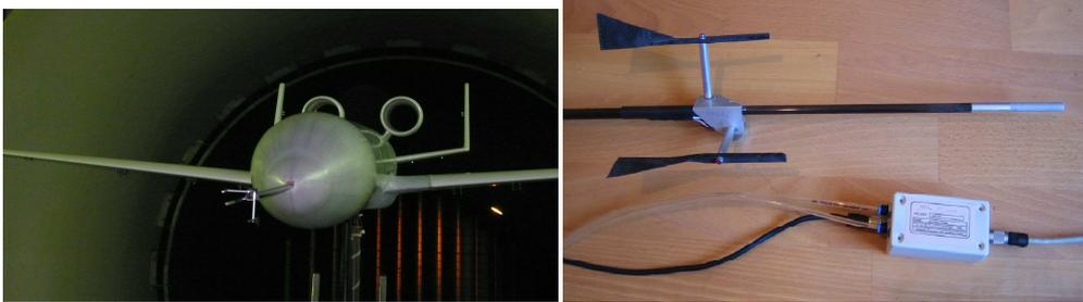
Abbildung 27 Luftdatensonde während des *Full Scale*-Windkanalversuchs (links, Quelle: Universität Stuttgart) und mit Verarbeitungselektronik (rechts, Quelle: Ingenieurbüro SFL-GmbH)
