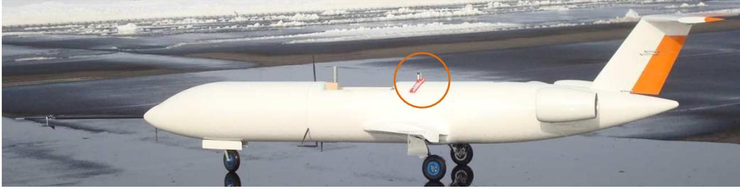
Abbildung 76 Fluggerät mit gestecktem *Safety Pin*
