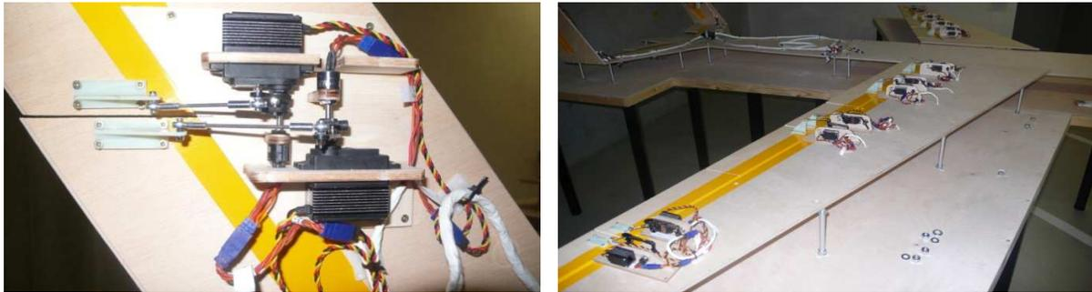
Abbildung 74 *Iron Bird*-Klappenaktuatorik mit Positionsmessung
