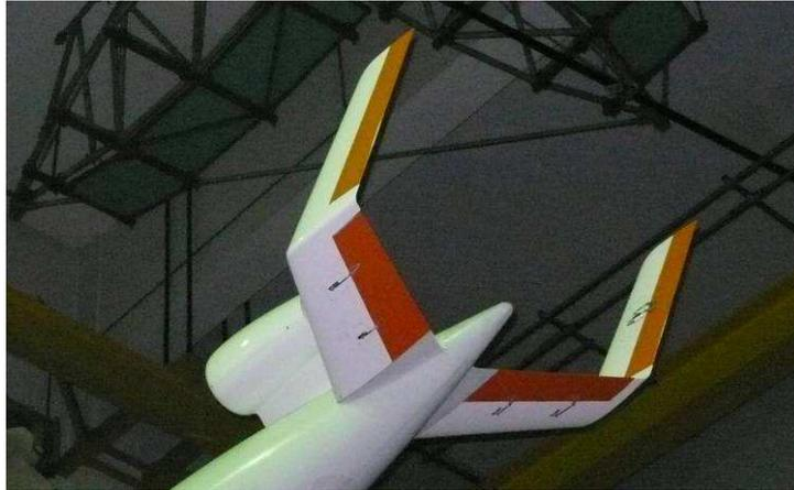
Abbildung 194 U-Leitwerkskonfiguration
