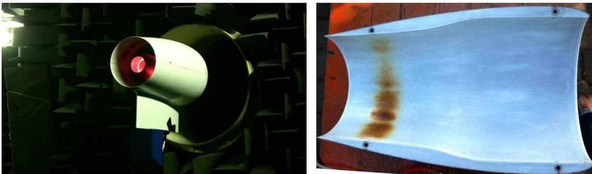
**Abbildung 113 Einflüsse der Hitzestrahlung des Triebwerksauslasses auf die Gondel**
