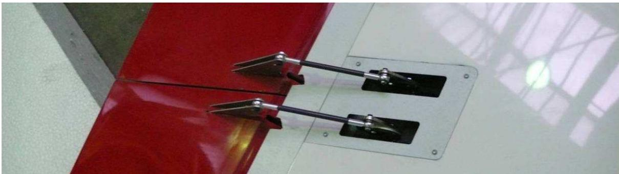
Abbildung 187 Servokinematik der Landeklappen
