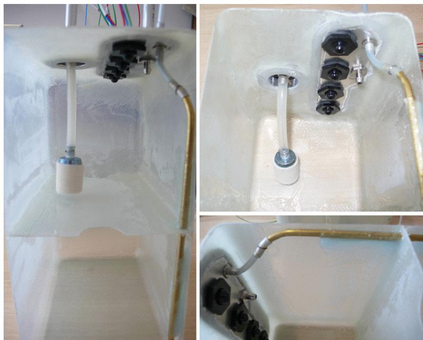
Abbildung 46 Innerer Aufbau der Hoppertanks
