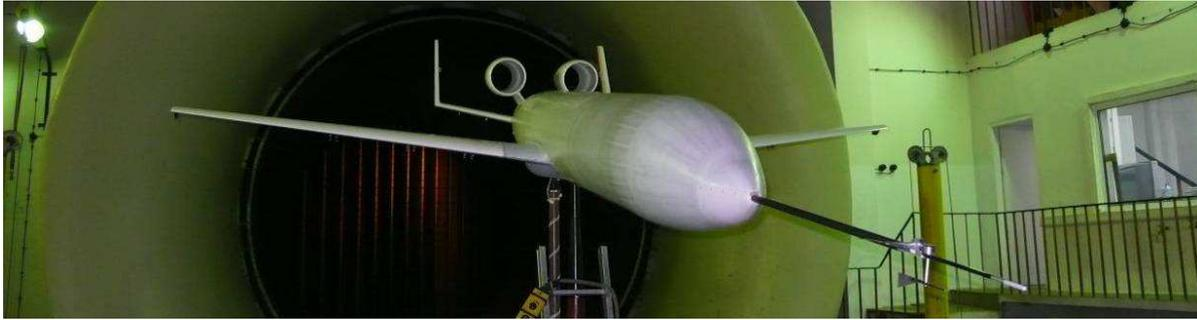
Abbildung 145 Messplattform im Windkanal (*Institute of Aviation, Warschau, Polen, D=5m*)
