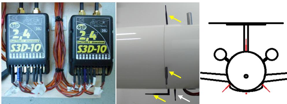
Abbildung 32 Empfänger und Antennenkonfiguration am Rumpf (gelbe Pfeile markieren RC-Antennen, weißer Pfeil markiert Telemetrie-Antenne), rechts: Aufteilung der RC-Antennen am Rumpf
