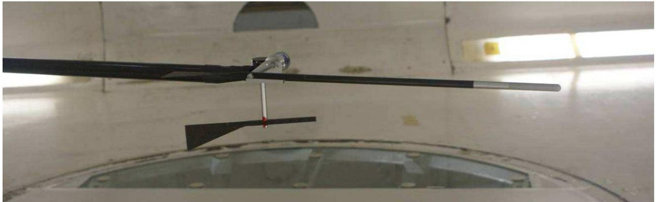
Abbildung 138 Luftdatensonde im Laminarwindkanal
