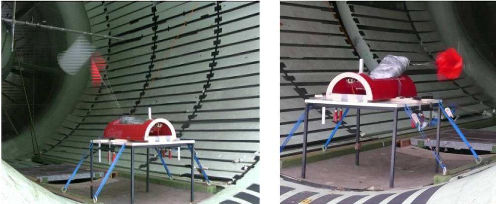
Abbildung 136 Auslösetests Fallschirmsystem im Windkanal
