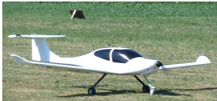
**Abbildung 164 Trägerplattform DA40 im Maßstab 1:4**
