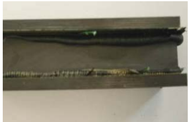
Bild 106 Deformation einer Kurzfaserschweißung (V_kf_21)
