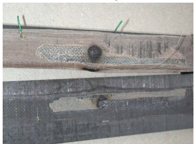
Bild 41 Prozessabbruch aufgrund lokaler Stromkurzschlüsse
