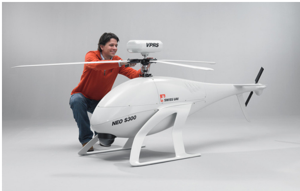
(c): Kommerzielles Helikopter-UAV „NEO S-300“ der Firma „SWISS UAV“ mit Dieselmotor 3
