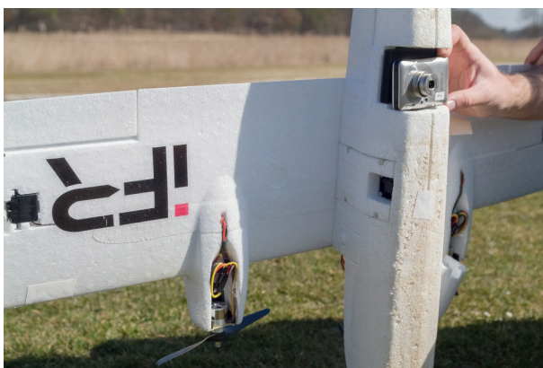
Abb. 3.7: Canon-Kamera in der Aussparung im Rumpf der Twinstar II
