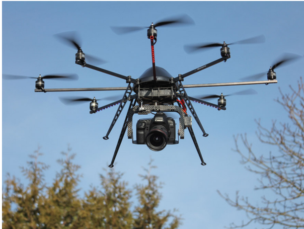
(a): Als Bausatz erhältlicher Oktokopter der Fa. HiSystems GmbH ( mikrokoetter.de ) 1
