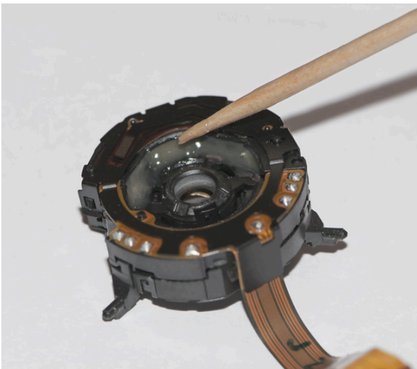
Abb. B.17: Klebestelle an der Bildstabilisator-Linse
