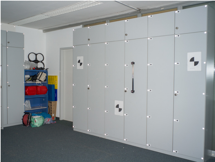
Abb. 4.3: 2D-Indoor-Testfeld mit AICON-Maßstab im ifp-Labor
