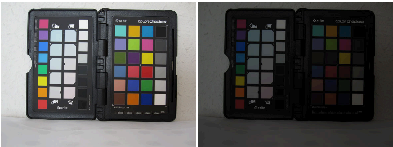
Abb. 3.12: Verdunklung des Bildes durch Aktivierung des ND-Filters bei gleicher Verschlusszeit
