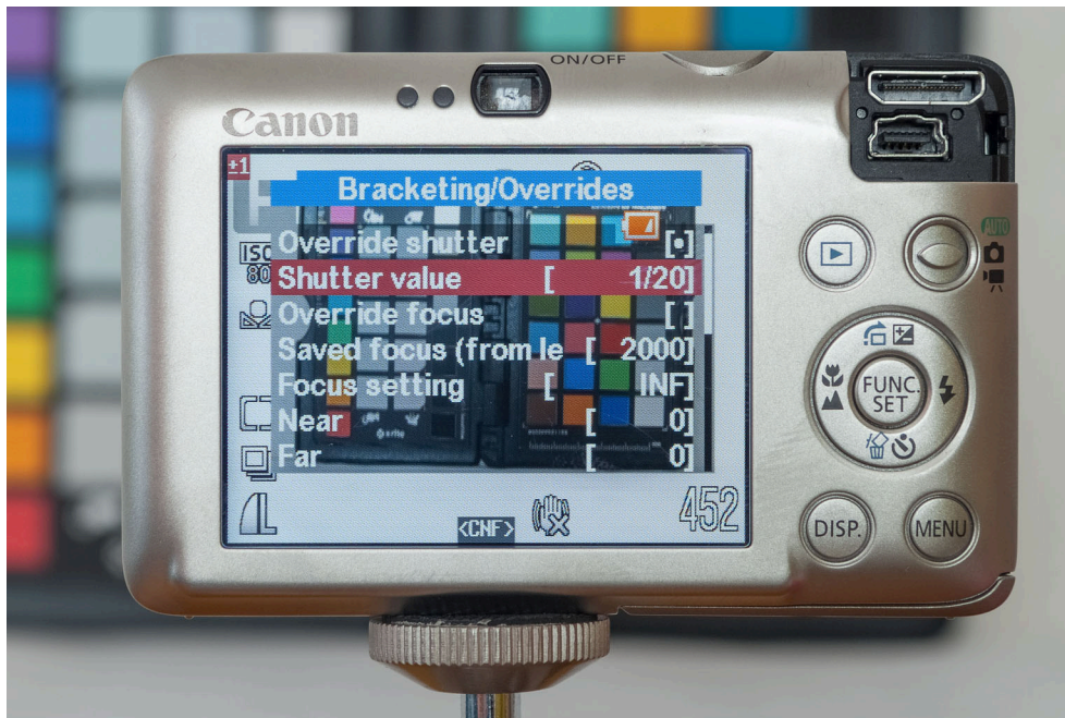
Abb. 3.17: Manuelle Einstellung der Belichtungszeit bei der Canon-Kamera mittels SDM
