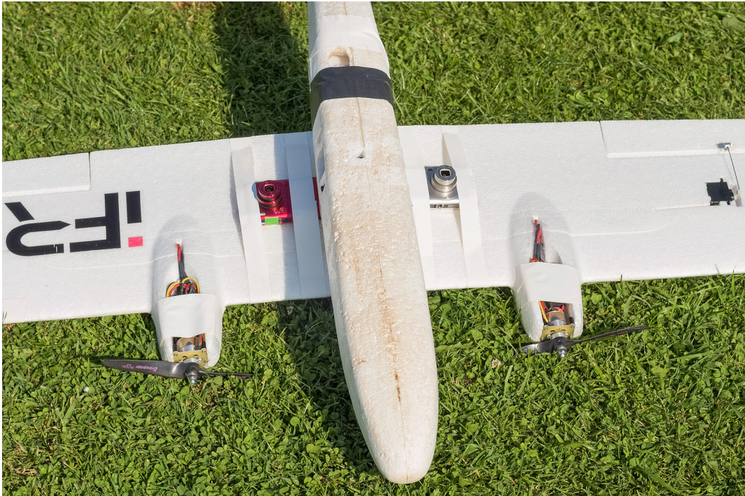
Abb. 3.22: Canon-Kameras an den Tragflächen des Twinstar-UAVs beim Videotestflug
