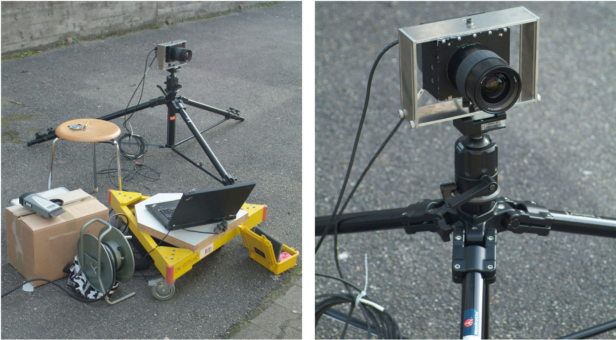
Abb. 5.2: Kamerastandpunkt, DigiCAM und Stativ mit Rahmen zur Verkantung
