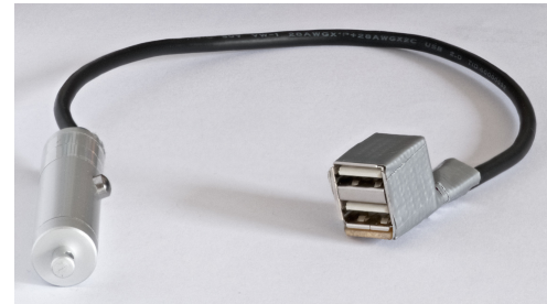
Abb. 3.25: Eigener Kabelauslöser mit zwei USB-Anschlüssen
