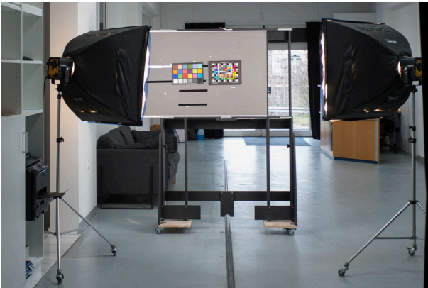
Abb. 4.60: Aufbau beim Test auf Farbtreue
