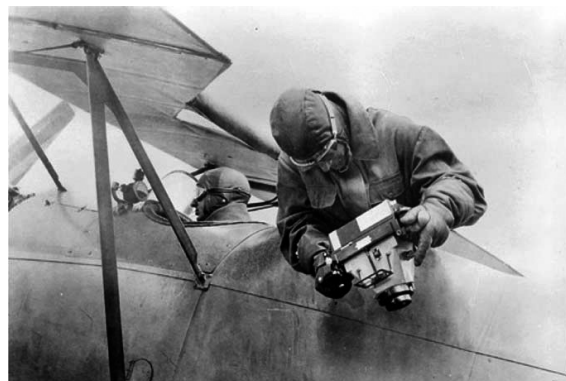
Abb. 1.2: Schrägaufnahmen aus einem bemannten Flugzeug mit der Wild C2 um 1925. Quelle: SANDAU (2005, S. 2)
