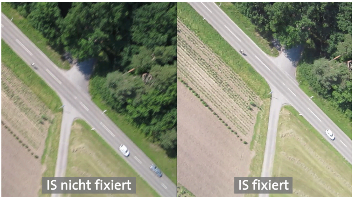
Abb. 3.23: Screenshot aus dem Video zum Vergleich von unmodifizierter und modifizierter Canon-Kamera
