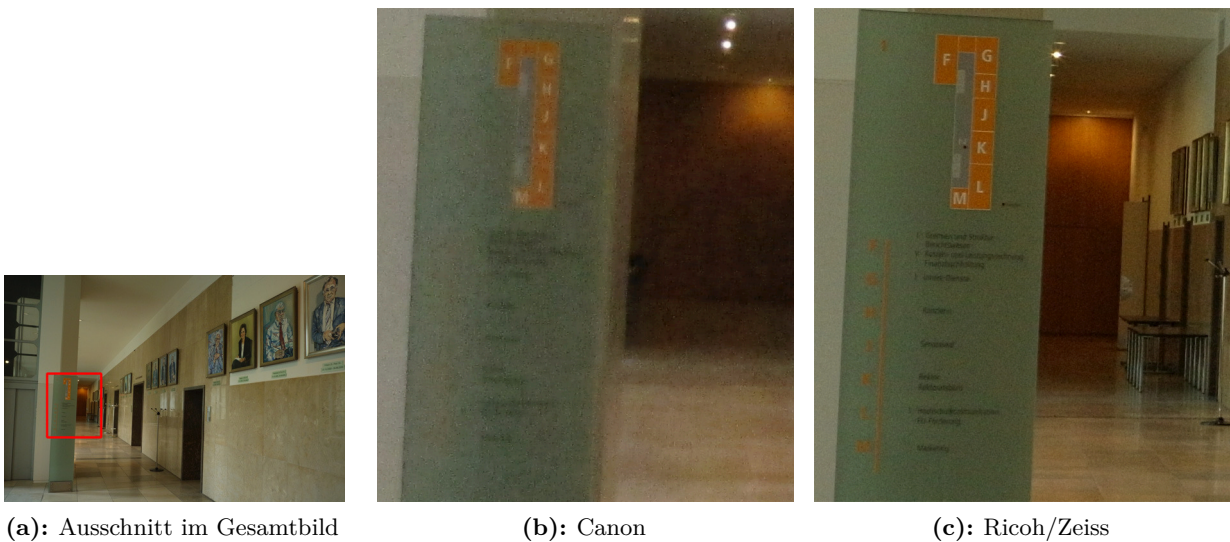
Abb. 4.53: Eindruck des Bildrauschens – Canon vs. Ricoh/Zeiss (JPG)
