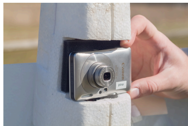
Abb. 3.7: Canon-Kamera in der Aussparung im Rumpf der Twinstar II
