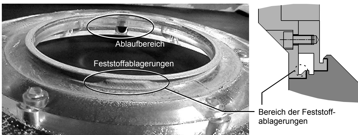
Bild 5.19 Dichtsystem 3 - Feststoffablagerungen im oberen Bereich der Fangkammer nach drei Stunden Dickstoffbeaufschlagung; Drehzahlzyklus 0-10000 1/min in beide Drehrichtungen
