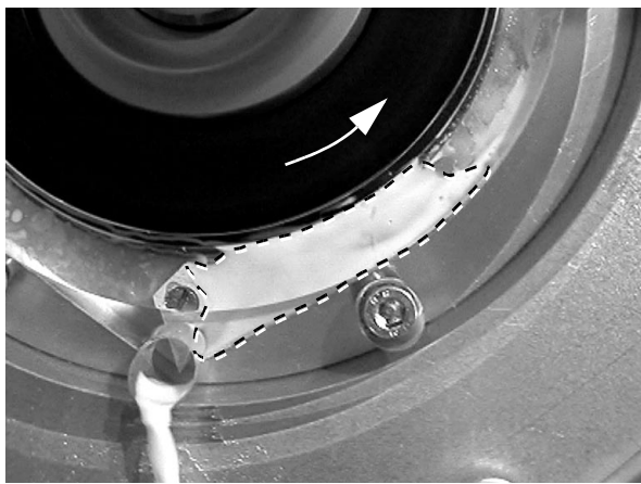
Bild 5.21 Dichtsystem 3.1 - Drossel im Ablaufbereich; Strömungsverhalten im Ablaufbereich der Fangkammer
