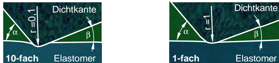
Bild 7-17: Schliffbilder von Harzeingüssen: r = 0,1 mm (links) und r = 1 mm (rechts)
