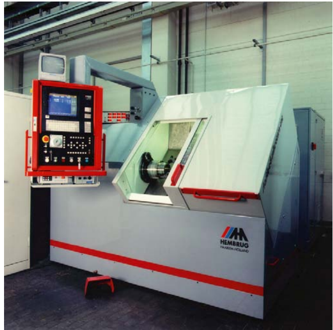
Bild 26: Präzisionsdrehmaschine Hembrug Slanted Microturn CNC
