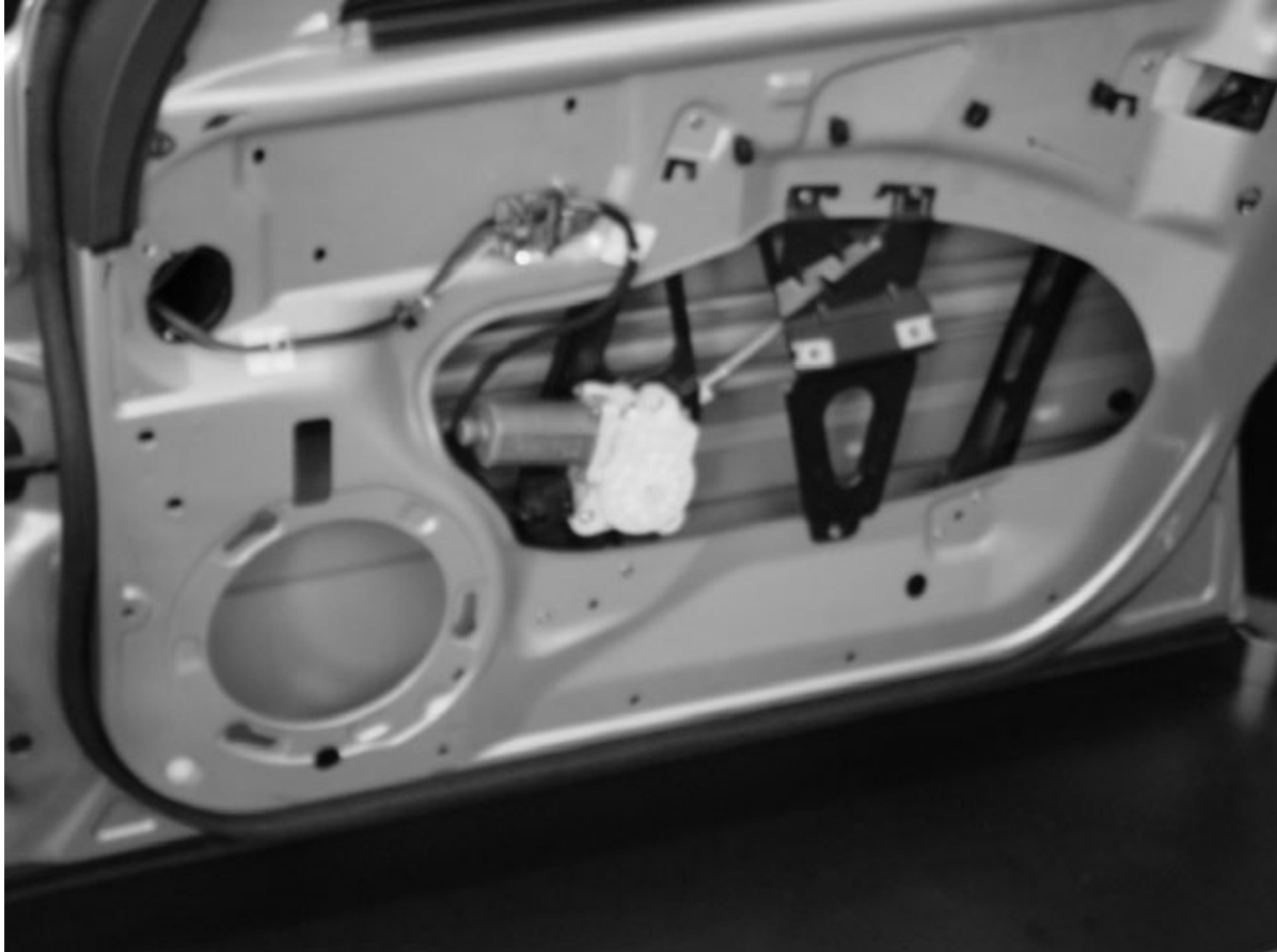
Abb. 6-1: Türmodul mit integriertem Fensterheber einer Mercedes E-Klasse BR211
