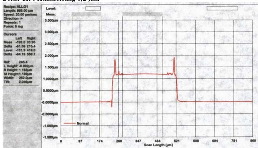
Bild 140: geometrischer Tastschnitt über die Probe mit Oxidschicht. Beschriftung der Abszisse: Scanlänge 0 – 868 µm in 10 Schritten; Ordinate: -1,5 – 3,5 µm in 10 Schritten. Dicke der Metallisierung 1,2 µm, Spitzenhöhe ca. 0,6 µm.
