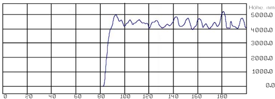
Bild 37: Profilometrie der verwendeten Proben – Die Dicke liegt zwischen 4 und 5, an anderen Stellen bis zu 6 µm, mit einer Rauhmigkeit von etwa 1 µm.
