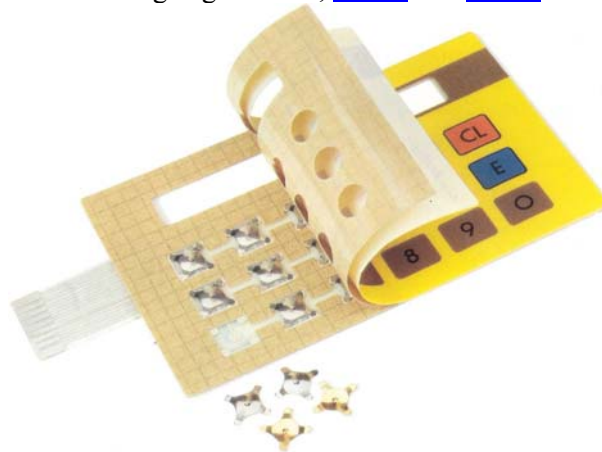
Bild 8: Folientastatur, Beispiel (Kundisch Electronic [8])
