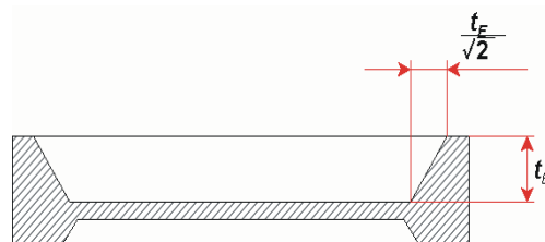
Bild 120: Böschungsbreite der Ätzgrube.
