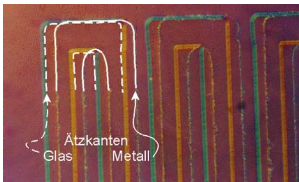
Bild 85: Glaswafer mit ins Glas eingesenkter Leiterbahn. Glasstrukturen bilden sich schärfer ab als Metallstrukturen.
