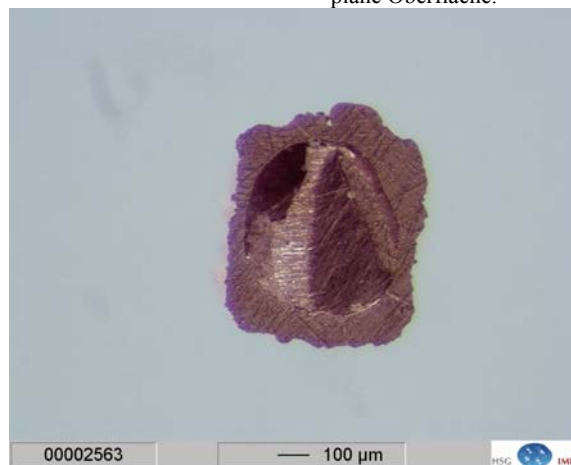
Bild 107: Prozessfehler – Hohlraum in der Füllung durch Lufteinschluss bei Prozessbeginn.
