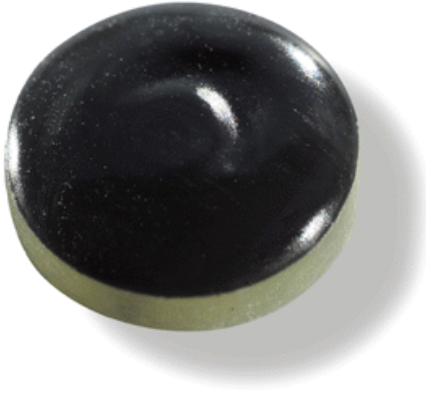
Bild 154: Schalter auf Demonstratorleiterplatte, komplett vergossen
