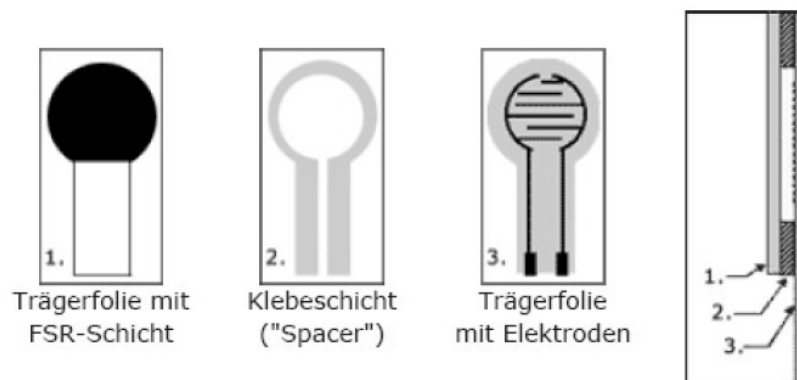
Abbildung 3.15: Schematische Darstellung zum Aufbau eines Force-Sensing-Resistor (FSR), [52]
