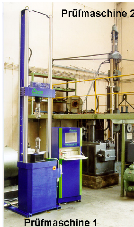
Abbildung 5.2: Im Rahmen dieser Arbeit eingesetzte Zugswellprüfmaschinen
