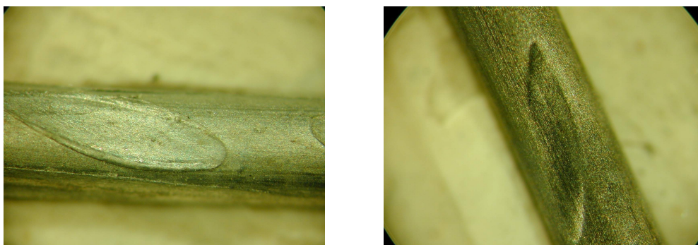
Abbildung 5.8: Kontaktstellen an der 2. Drahtlage (Außenlage) Seil Nr.3 (OSS 1x19) vor (links) und nach (rechts) dem Entzinken
