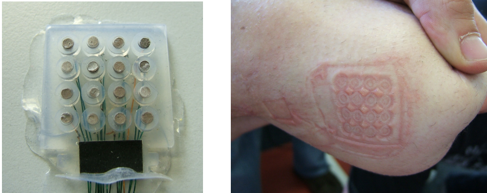
Abbildung 4.1: Das EMG-Array aus der ersten Versuchsreihe (links). Die einzelnen Elektroden üben einen zu starken Druck auf die Hautoberfläche aus, und das umgebende Gewebe drückt sich lokal zu stark in die Zwischenräume der Elektroden-Sockel (rechts).
