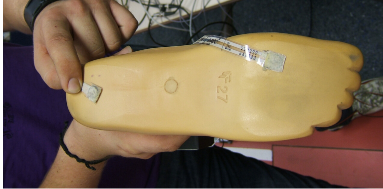
Abbildung 4.5: Drucksensoren unter der Fußsohle des Prothesenfusses
