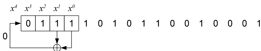
Abb. 2.11: 4-Bit LFSR bei der Erzeugung des letzten Bits für das 2^4 - 1 = 15 -te Codewort der Pseudo-Zufalls-Sequenz nach [Wiki11, LFSR].
